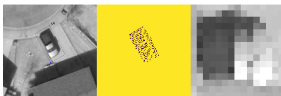
FIGURE 4.7 – De gauche à droite : une région d'intérêt et sa paramétrisation dans l'image de départ, les emplacements des pixels des maxima poolés dans l'image de départ (argmax)(backward), les pixels poolés réordonnés par le RoI pooling tournant (on utilise l'image d'origine pour une visualisation plus compréhensible)(forward)
