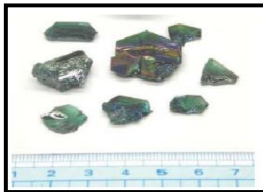
Figure 1: Carbure de silicium (principalement SiC-6H) obtenue par la méthode de Acheson.
