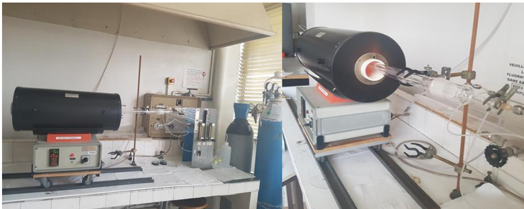
Figure 36: Four résistif utilisé pour les recuits des échantillons de SiC implantés et irradiés.
