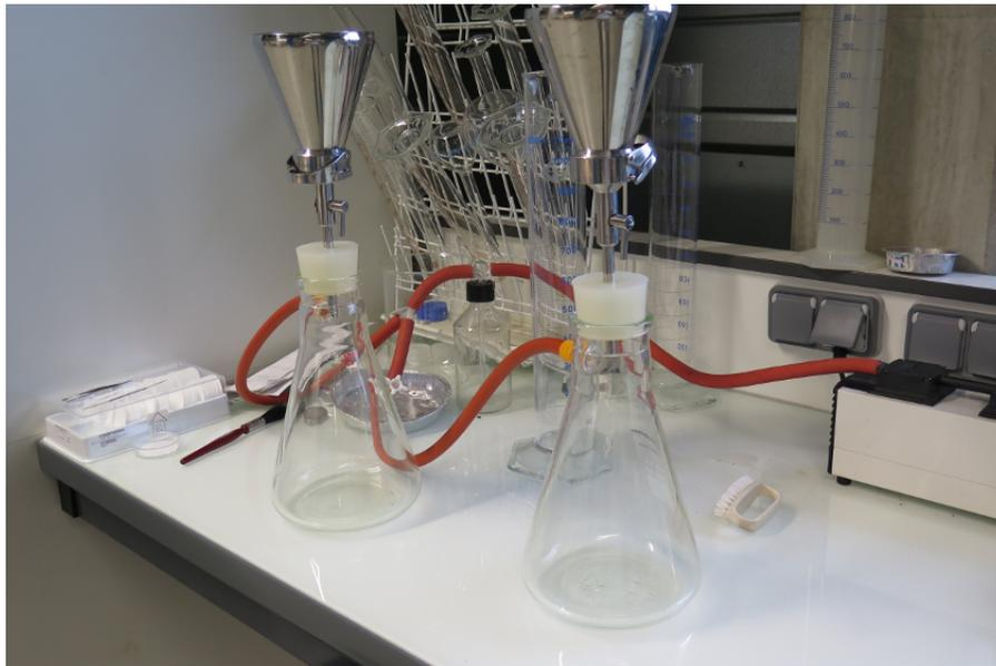
FIGURE 3.10 – Matériel de filtration utilisé pour les mesures de concentration massique à Irstea Lyon.
