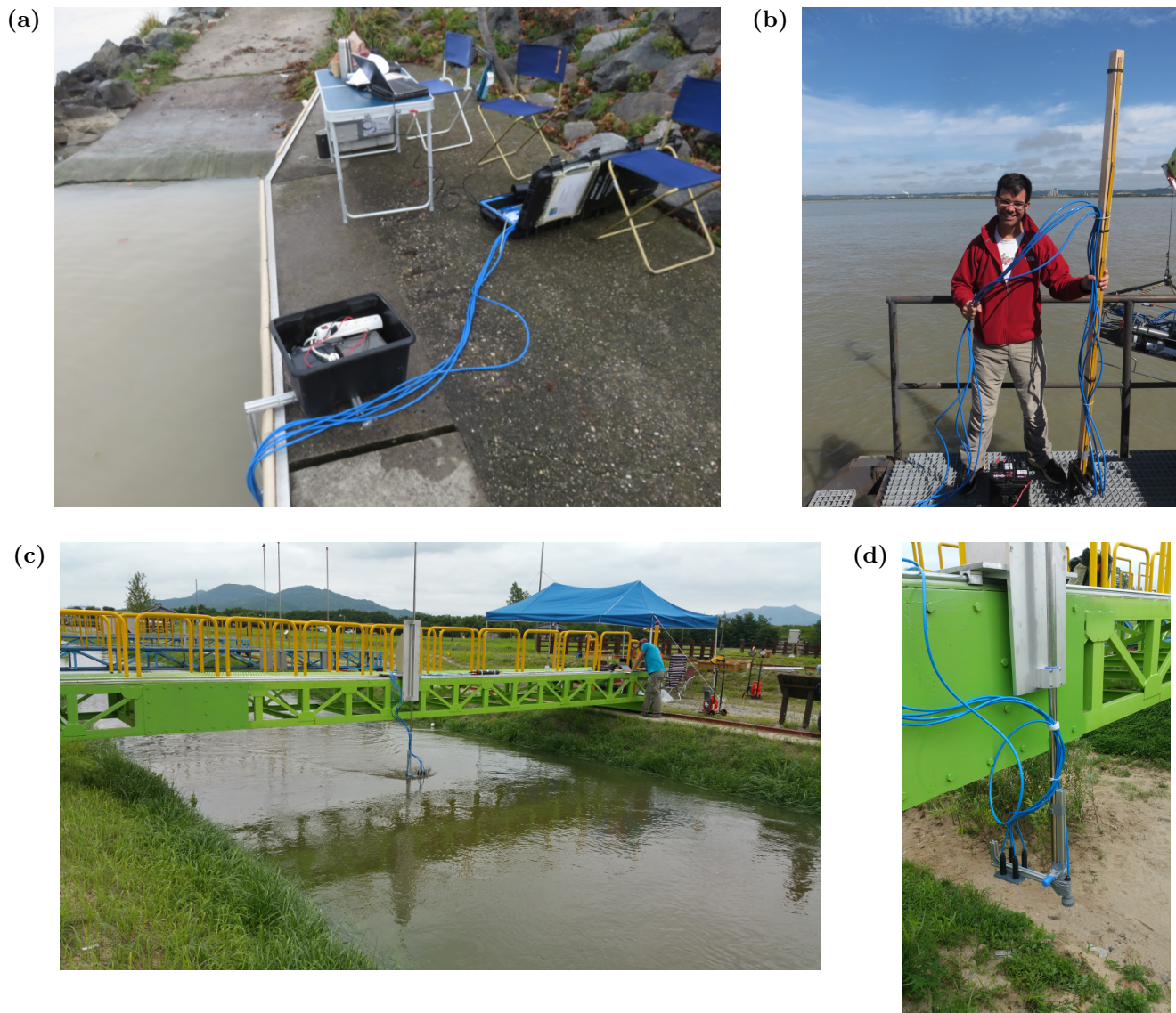
FIGURE 3.30 – Déploiement sur un support fixe (a) dans le Rhône depuis la berge (Lyon); (b) transducteurs fixés sur une perche de déploiement tenue à la main (estuaire de la Seine); (c) - (d) depuis un pont roulant au KICT River Experiment Center (Corée du Sud).
