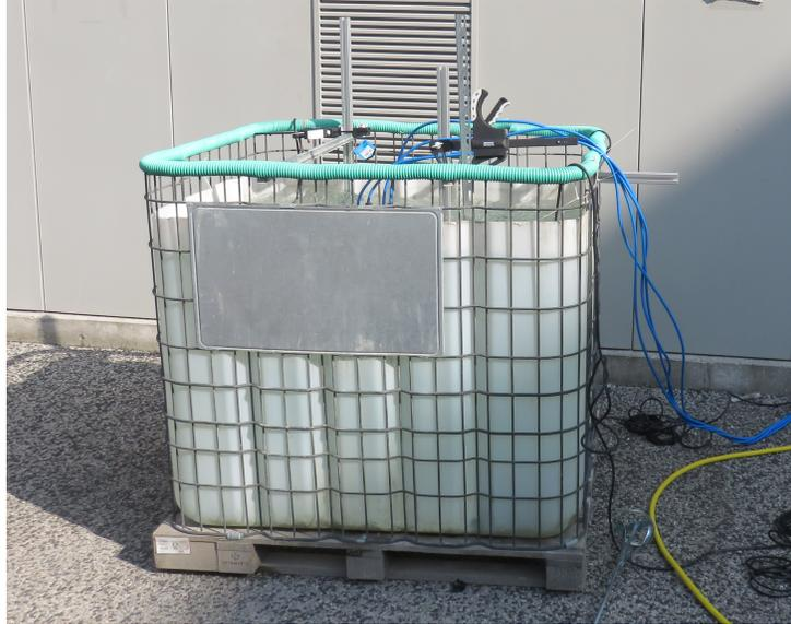
FIGURE 3.13 – Cuve de  $1 \text{ m}^3$  ( $1 \times 1 \times 1 \text{ m}$ ) utilisée pour les expériences à Irstea Lyon
