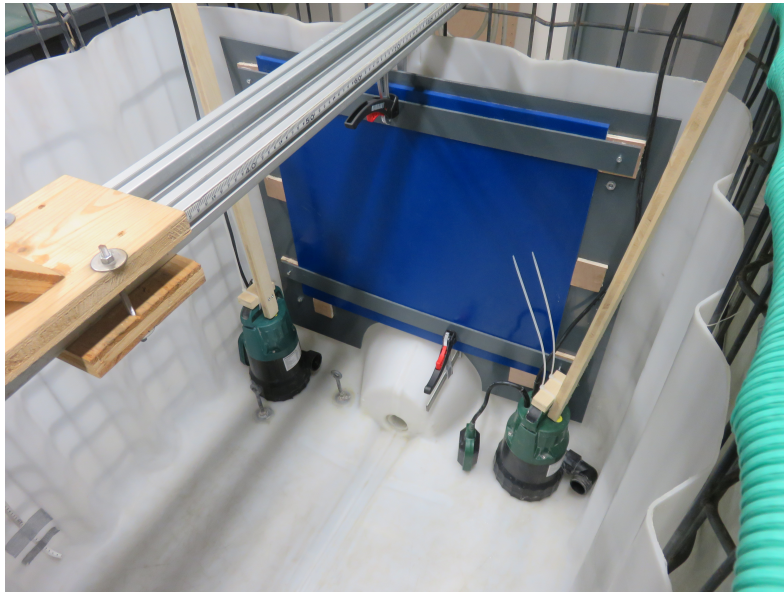
FIGURE 3.26 – Plaque d’isolant ultrasonique (Precision Acoustics Aptflex 28) placée face aux transducteurs pour éviter la saturation de la réflexion dans la cuve expérimentale
