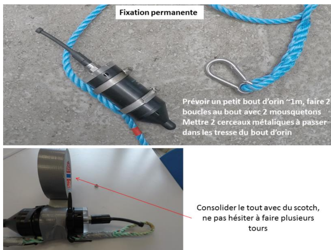
Figure 3 : système permanent d'accroche du soundtrap
