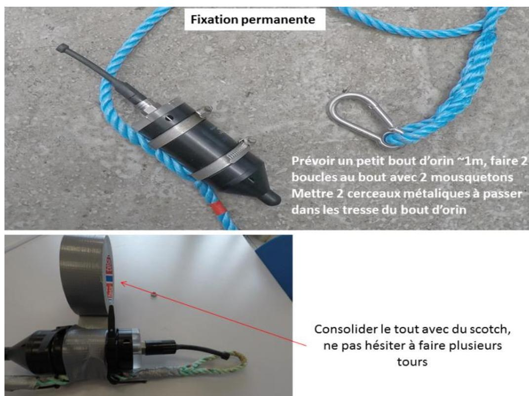
Figure 3 : système permanent d'accroche du soundtrap
