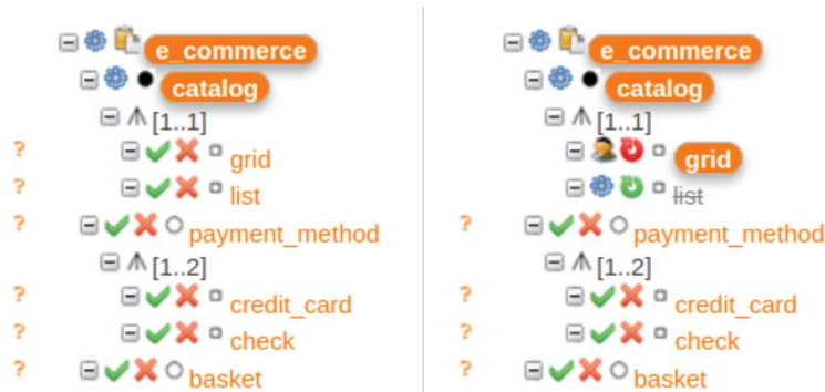
FIGURE 4.21 – (Gauche) Configurateur sans aucune décision de l'utilisateur. (Droite) Configurateur après que l'utilisateur ait sélectionné grid
