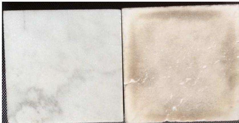
Figure II-9 : Echantillon sain (à gauche) et après altération (à droite)
