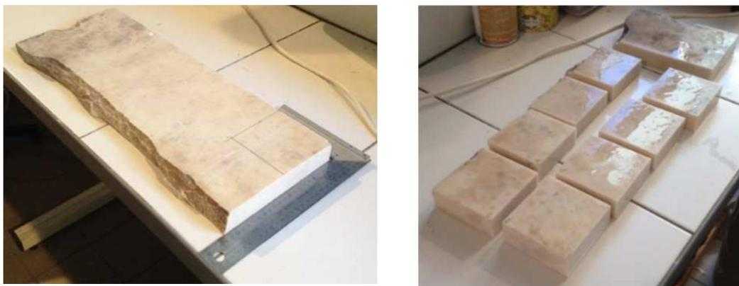
Figure II-4 : le bloc de marbre et les échantillons de marbre découpés (BILUSTYAK).
