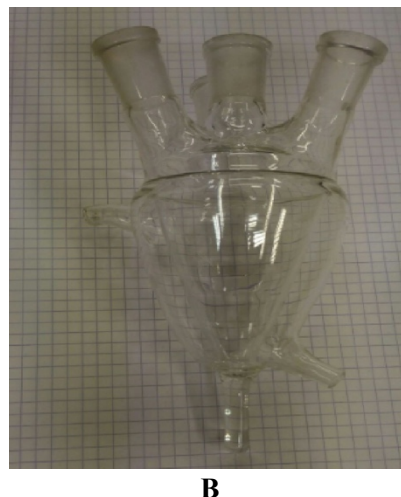
Fig. II- 1: Schéma d'une cellule électrochimique (A) et photographie de type de cellule utilisé à ICMMO-ERIEE (B).
