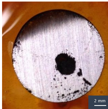
Figure III-20 : photographie de la surface de l'électrode Macki5 après polissage léger au papier SiC grade 600
