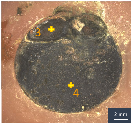
Figure III-14 : photographie de la surface de l'électrode Macki3 après grattage d'une partie de la couche de produits de corrosion
