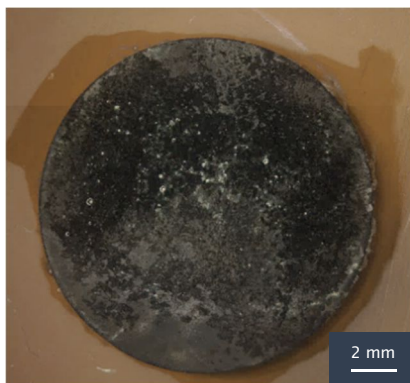
Figure III-36 : photographie de la surface de l'électrode Mag3 après 4 jours de polarisation à 50 \mu\text{A}/\text{cm}^2 dans la solution S3 à pH 10
