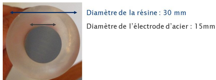
Figure II-3 : surface de l'électrode en contact avec le milieu (électrolyte, matériau de remplissage, argilites...)
