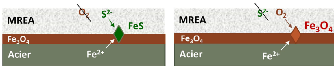
Figure IV-20 : schéma d'un phénomène représentant la formation de mackinawite (à gauche) ou la formation de magnétite (à droite) suite à la création d'une zone anodique
