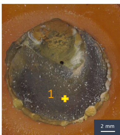
Figure III-17 : photographie de la surface de l'électrode Macki6 (à gauche) et spectre issu de l'analyse Raman de la partie externe de la couche recouvrant l'électrode Macki6 (à droite) polarisée à 50 \mu\text{A}/\text{cm}^2 durant 7 jours à 80^\circ\text{C} dans la solution désaérée S7 ; M : magnétite
