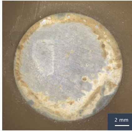
Figure IV-2 : photographie de l'état de surface de l'acier API 5L X65 après l'essai de polarisation en solution désaérée de 0,01 M NaCl + 0,01 M NaHCO 3 à pH = 7 à 80°C
