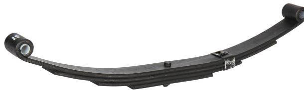
FIGURE 1.16 – Suspension de type ressort à lames
