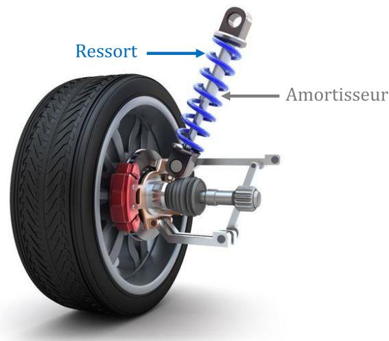
FIGURE 1.11 – Système de suspension traditionnel (ressort hélicoïdal et amortisseur hydraulique) relié à la roue
