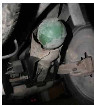
(a) Suspension montée sur véhicule
