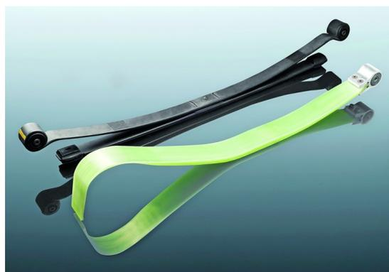
(b) Ressort à lames avec faisceaux auxiliaires (en noir) et composite (en vert)
