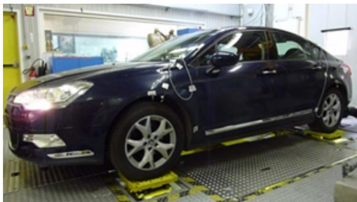
FIGURE 2.20 – Véhicule Citroën C5 équipé de la suspension CRONE Hydractive lors de tests sur un banc quatre vérins
