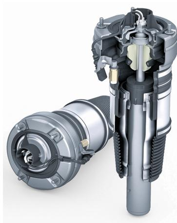
FIGURE 2.1 – Jambe de force du système de suspension AirMatic
