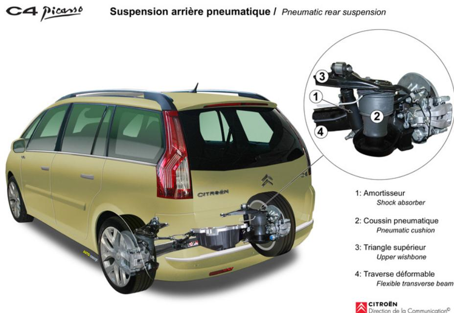
FIGURE 1.39 – La Citroën Grand C4 Picasso équipée de suspensions arrières pneumatiques dans sa version « Exclusive »
