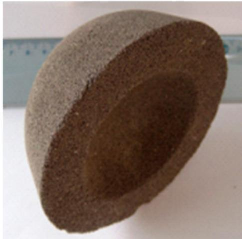
FIGURE B.3 – Massif poreux de la version passive monosphère de la suspension CRONE
