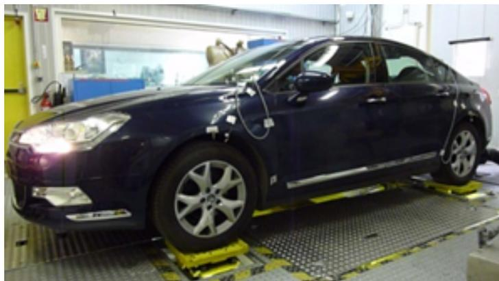
(a) Véhicule Citroën C5 lors de tests sur un banc quatre vérins
