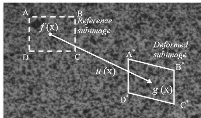
**Figure 1.17 :** Schéma explicite du sous-ensemble après et avant déformation (Alam 2011).
