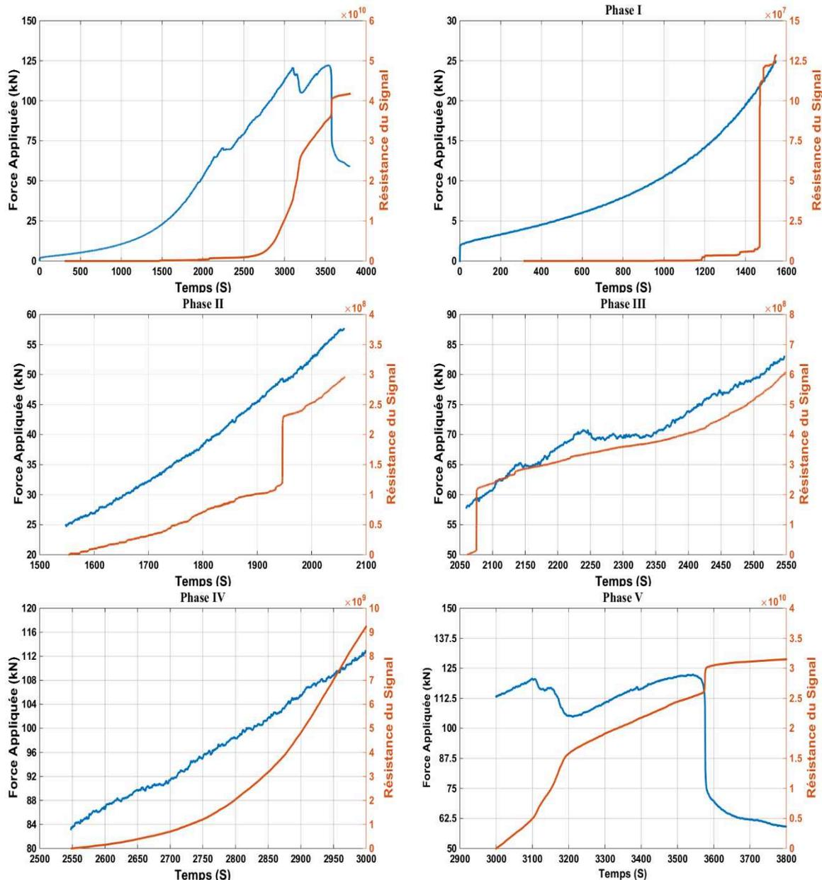
Figure 3.10 : Charge Appliquée et CSS pour la poutre D1.
