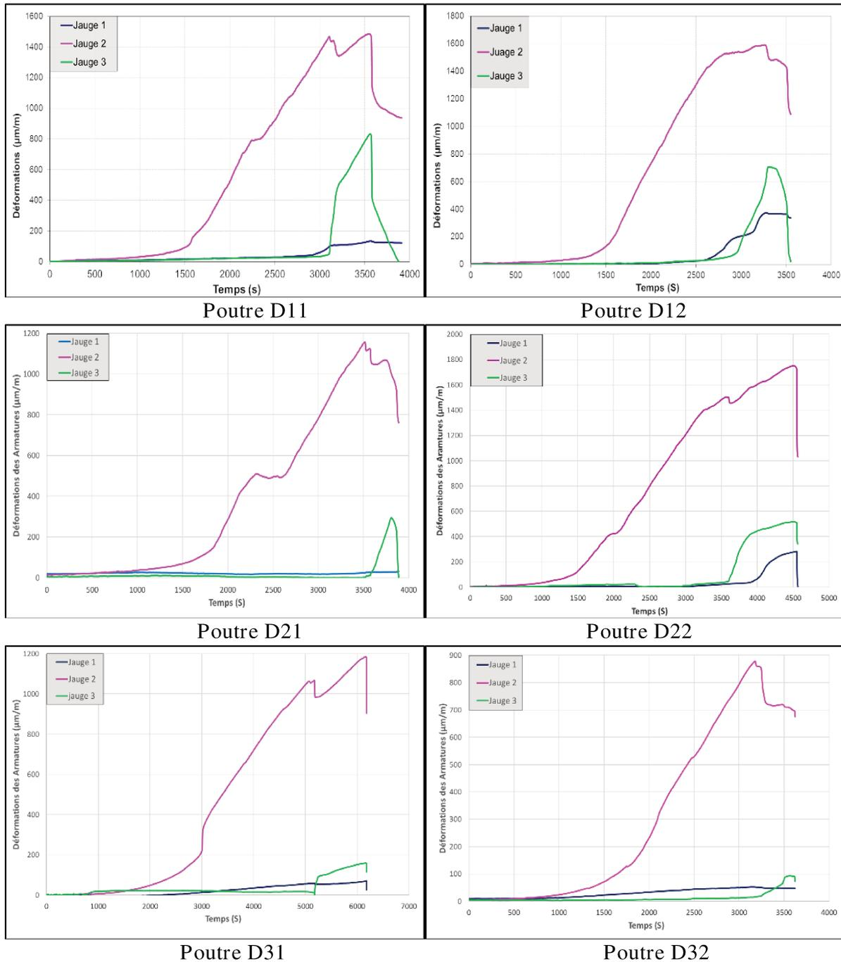
**Figure 2.10 :** Déformations longitudinales des armatures durant le test.
