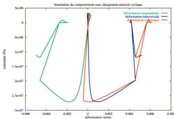
**Figure 4.8 :** Comportement uniaxial du béton(La Borderie 2003).
