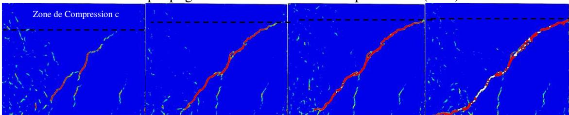
**Figure 4.12 :** Variation de la hauteur de la zone de compression durant le développement et la propagation des fissures dans la poutre D3 (D32).
