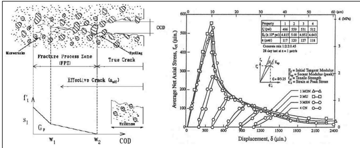
**Figure 1.6 :** La zone FPZ et la réponse post-fissuration en traction du béton (ASCE-ACI Committee 1998).
