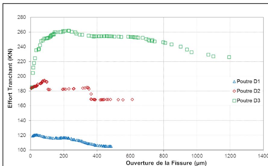
Figure 3.4 : Effort tranchant en fonction de l'ouverture de la fissure critique des trois tailles.
