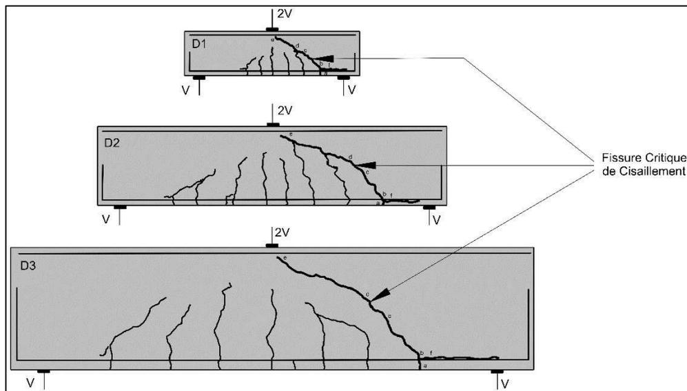
**Figure 2.9 :** Profils de fissurations pour les trois poutres.
