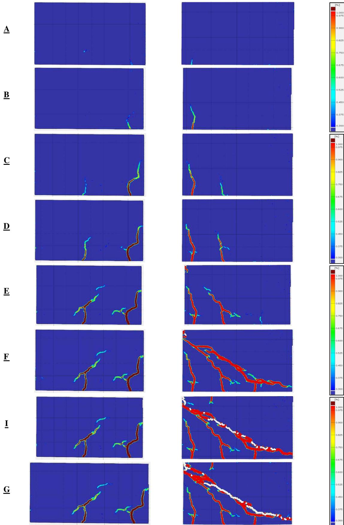
Figure 3.2 : Champs de déformation de la poutre D1.
