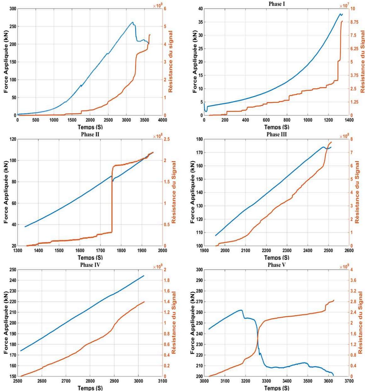
Figure 3.12 : Charge Appliquée et CSS pour la poutre D3.
