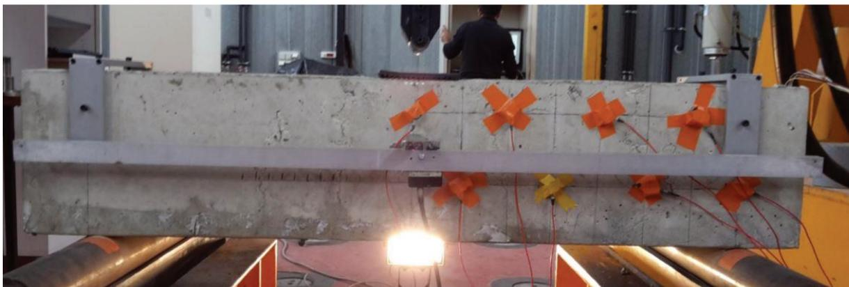
**Figure 2.3 :** Système de mesure de la flèche.
