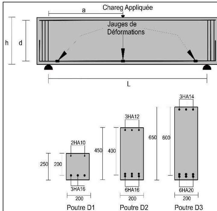
**Figure 2.1 :** Détails de ferrailage des poutres testées (Dimensions en mm).
