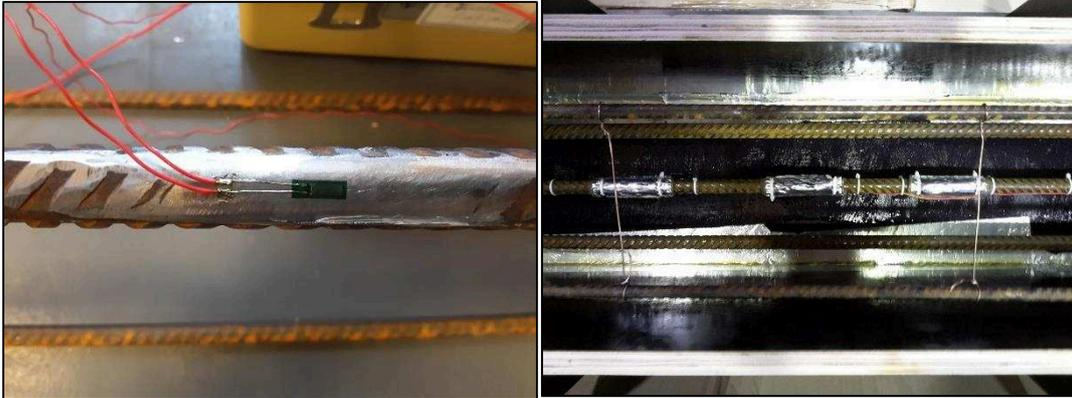
**Figure 2.4 :** Dispositif des jauges pour la mesure de déformations des aciers.
