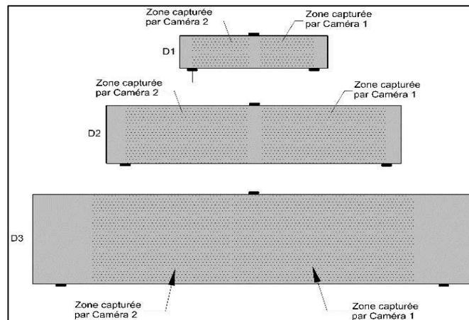
**Figure 2.5 :** les zones capturées par les caméras de la technique DIC.
