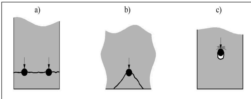
Figure 1.5 : Modes de rupture par effet de goujon.
