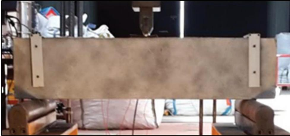
**Figure 2.2 :** Dispositif d'essai (flexion trois-points).
