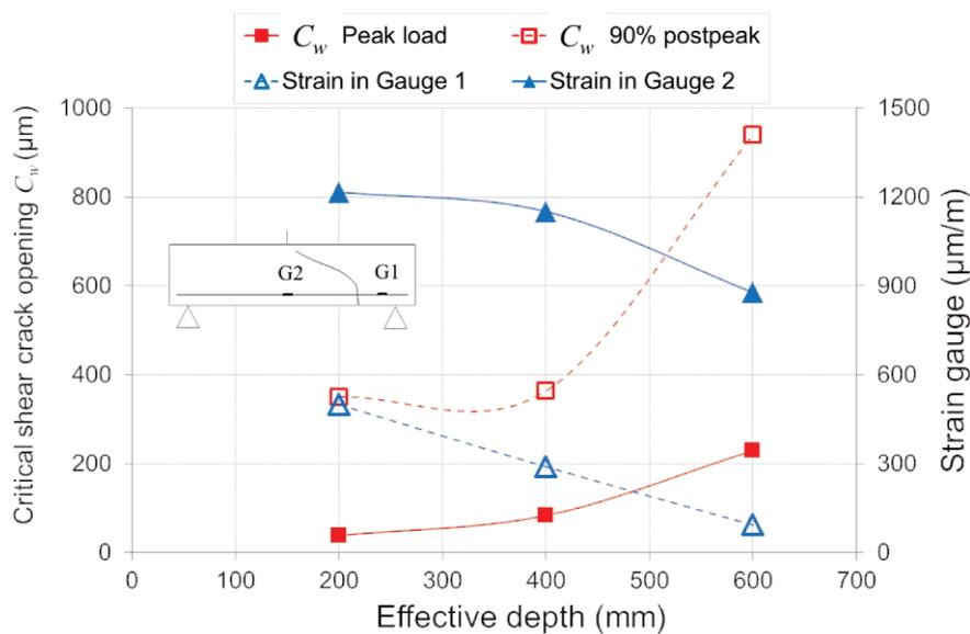
**Figure 4.6 :** Ouvertures de la fissure diagonale de cisaillement vs. Déformations des aciers.
