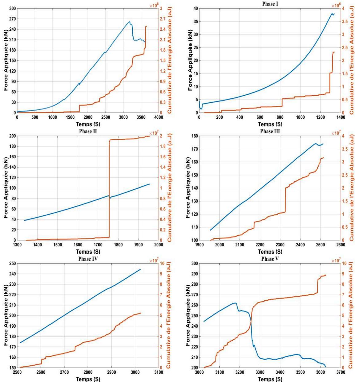
Figure 3.9 : Force appliquée et Energie Absolue vs Temps de la poutre D3.
