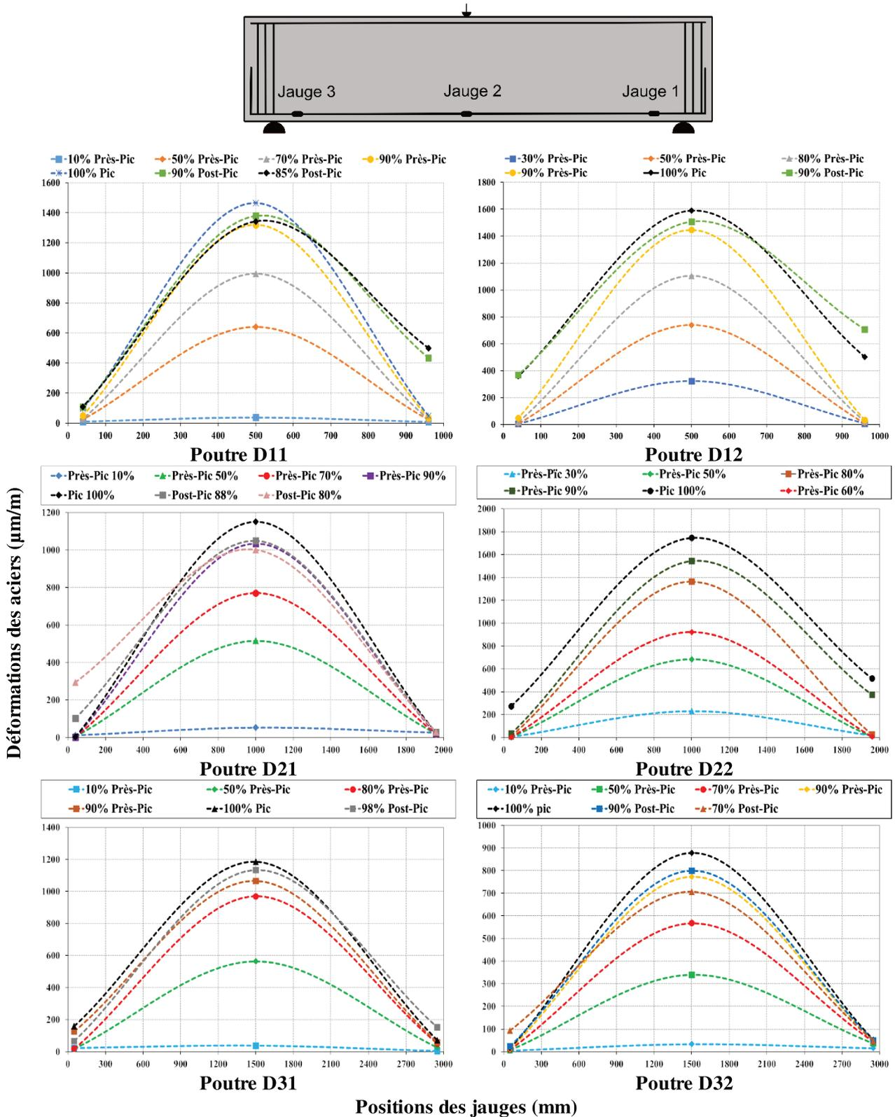
**Figure 2.11 :** Déformations des armatures longitudinales en fonction de la position et à différents taux de chargement.
