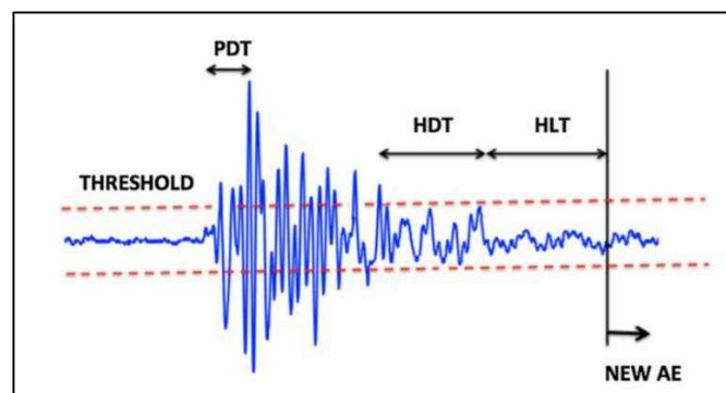
**Figure 2.7 :** paramètres pour l'acquisition des ondes acoustiques.
