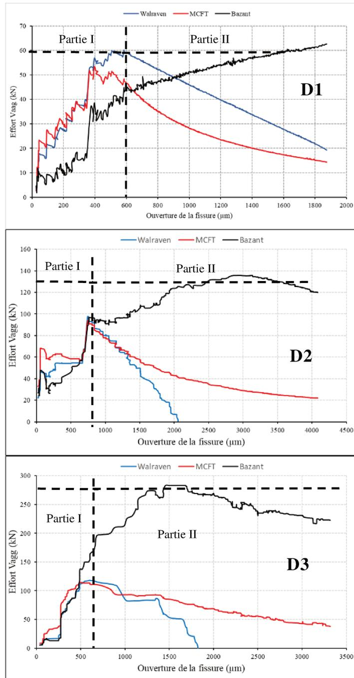
**Figure 4.13 :** Effort tranchant transmis par l'engrènement des granulats en fonction de l'ouverture de la fissure critique de cisaillement.
