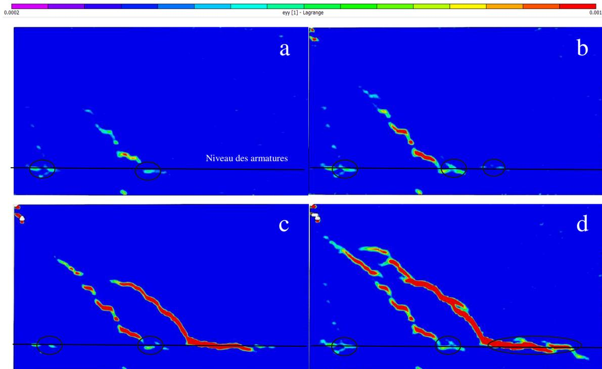
**Figure 4.5 :** Champs de déformations verticales de la poutre D11 à différents taux de chargement : (a) 87% Avant-Pic, (b) 100% Pic, (c) 96% Post-Pic, et (d) 90% Post-Pic.
