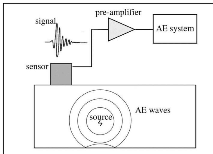
**Figure 1.18** : Principe de la technique AE (Van Bohemen 2004).
