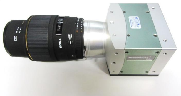
Figure 4.15 Caméra MotionBLITZ® Cube4 et objectif Sigma
