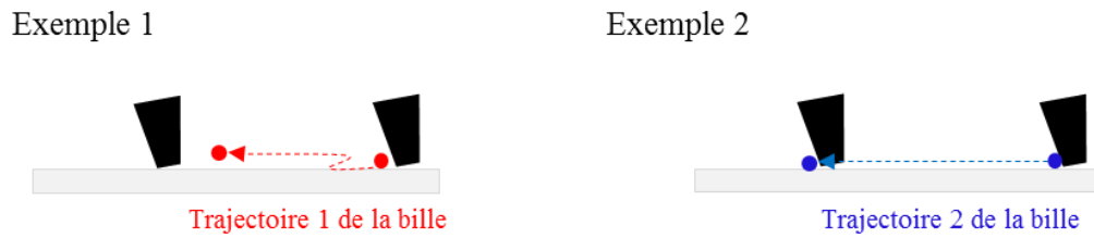
Figure 6.24 Schéma représentatif des différentes trajectoires de la bille de verre sur la surface lisse lors du passage de patin
