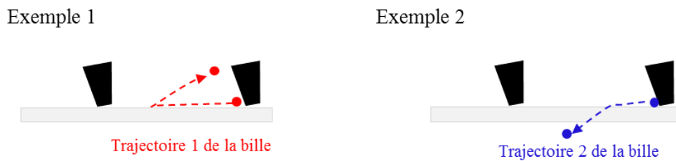
Figure 6.25 Schéma représentatif des différentes trajectoires de la bille de verre sur la surface grenailée lors du passage de patin
