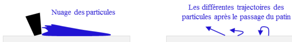
Figure 6.27 Schéma représentatif des différentes trajectoires des particules naturelles observés lors du passage de patin
