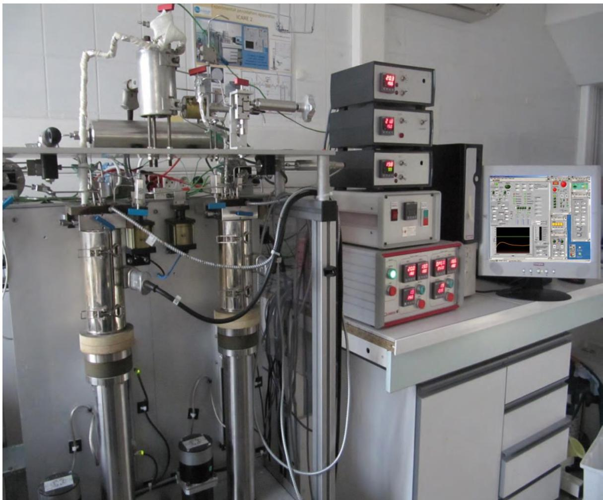
Figure 2.3. Photographie du banc de percolation ICARE 2 et du programme de commande Labview (Géosciences Montpellier).
