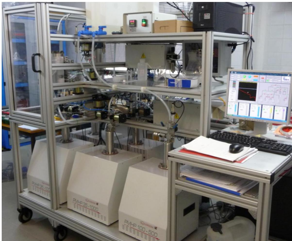
Figure 2.7. Photographie du banc de percolation ICARE 3 (Géosciences Montpellier).
