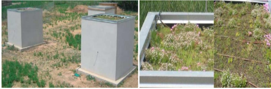
Figure I.6. Cellules test avec toit végétalisé [Pérez et al, 2012]
