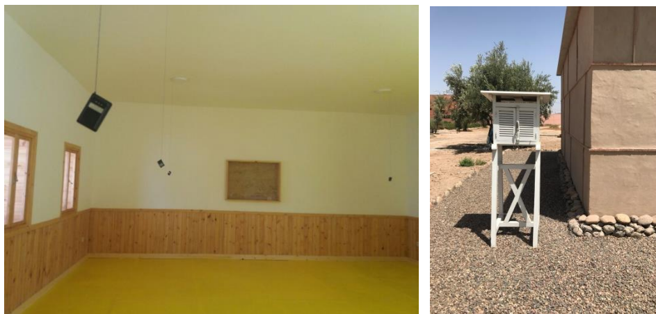
Figure II.12. Emplacement des dataloggers à l'intérieur du bâtiment étudié (à gauche) et à l'extérieur du bâtiment dans un abri météo (à droite).
