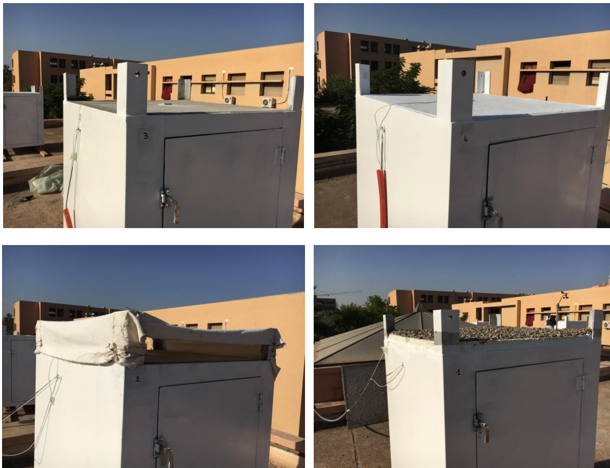
Figure III.2. Photos des quatre cellules test avec les techniques passives. De gauche à droite et de haut en bas: cellule de référence avec dalle nue, dalle peinte en blanc, toit ombragé et toit isolé thermiquement de l'extérieur
