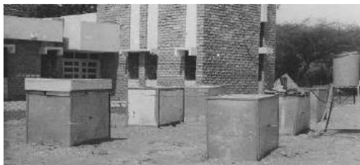
Figure I.1. Photo des cinq cellules test munies des techniques passives [Nahar et al, 1999]
