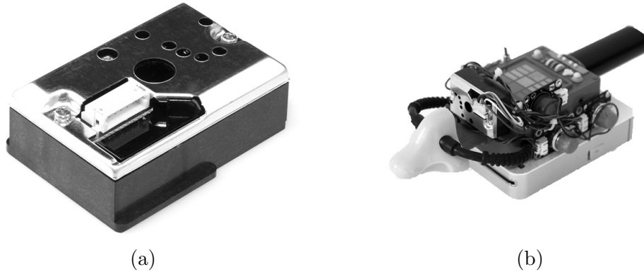
FIGURE 6.2 – (a) : un capteur de particules Sharp GP2Y1010AU0F . (b) : un projet amateur de mesure de la qualité de l’air.
