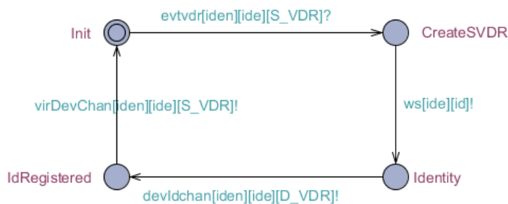
Figure 4.16 Modèle d'automate de la SVDR
