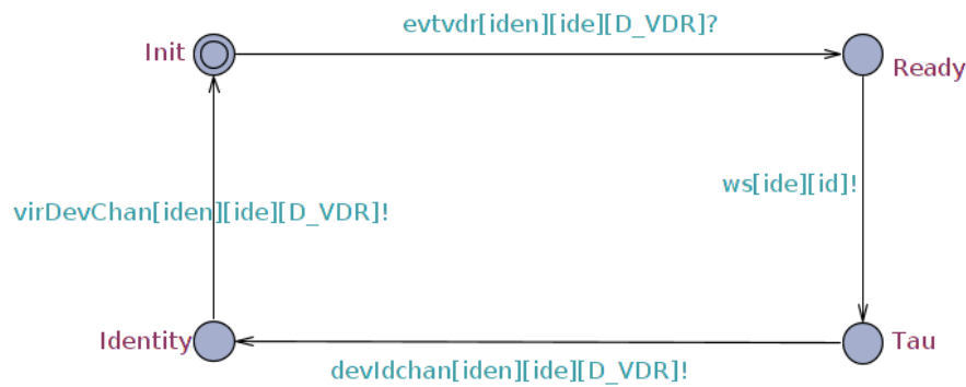
Figure 4.19 Modèle d'automate de la DVDR
