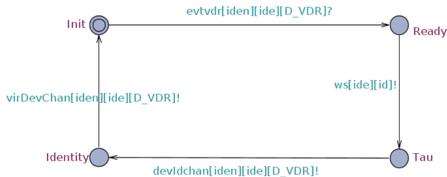
Figure 4.19 Modèle d'automate de la DVDR
