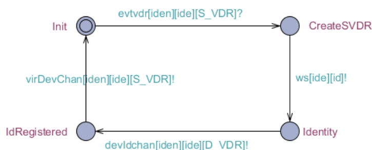
Figure 4.16 Modèle d'automate de la SVDR
