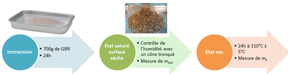
Figure 2-9 : schéma de l'essai d'absorption en eau des GBR
