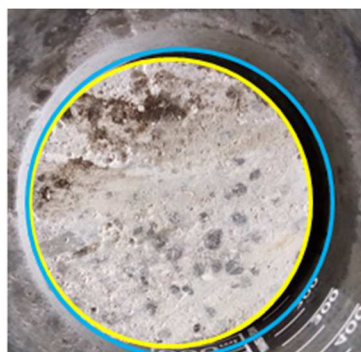
Figure 5-3 : photo d'un disque de mortier (cerclé de jaune) dans un bécher (paroi intérieure cerclée de bleu)
