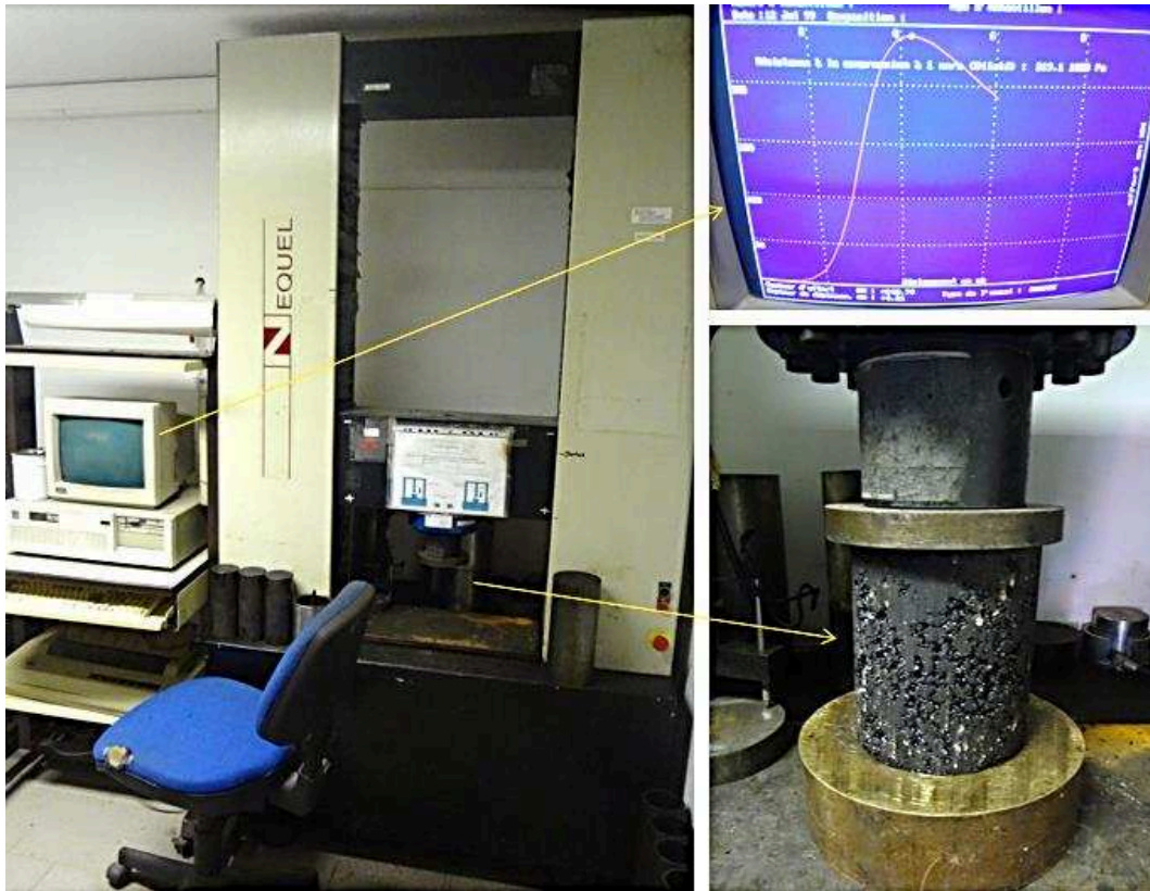
Figure III-8. Presse pour l'essai Duriez, laboratoire Le Foll TP.
