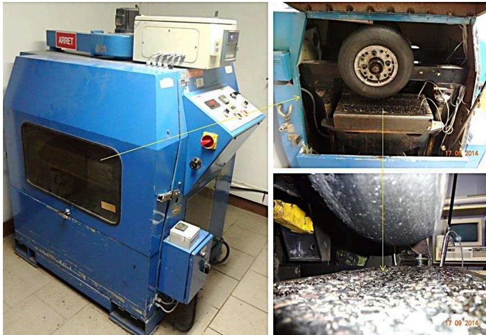
Figure III-15. Ornièreuse mlpc, laboratoire Le Foll TP.
