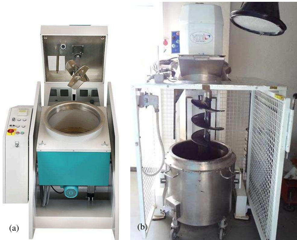
Figure II-10. Malaxeurs utilisés : (a) INFRATEST ( \leq 45 kg) et (b) VMI ( \leq 90 kg).
