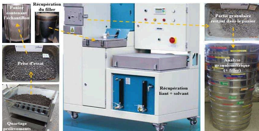
Figure II-2. Vérification de la granulométrie et la teneur en liant des AE.
