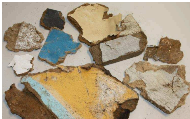
Figure 12 : Échantillons de déchets de panneaux MDF (dMDF) collectés dans un centre de recyclage
