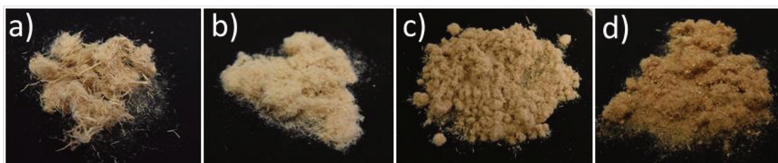
Figure 13 : Fibres de bois des quatre échantillons : (a): FV; (b): FE; (c): pMDF; (d): dMDF
