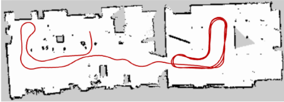
(a) Exemple de carte d'occupation 2D et de trajectoire obtenue par une approche SLAM. Extrait de [BSB + 15]
