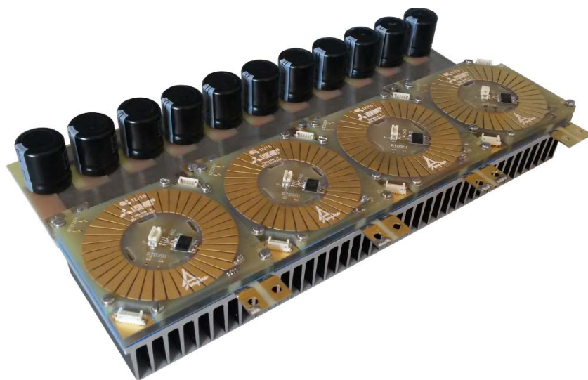
Figure 24: Photographie du PFC totalement assemblé avec les capacités. Les capacités doivent être remplacées par la capacité électronique pour réduire le volume du convertisseur.
