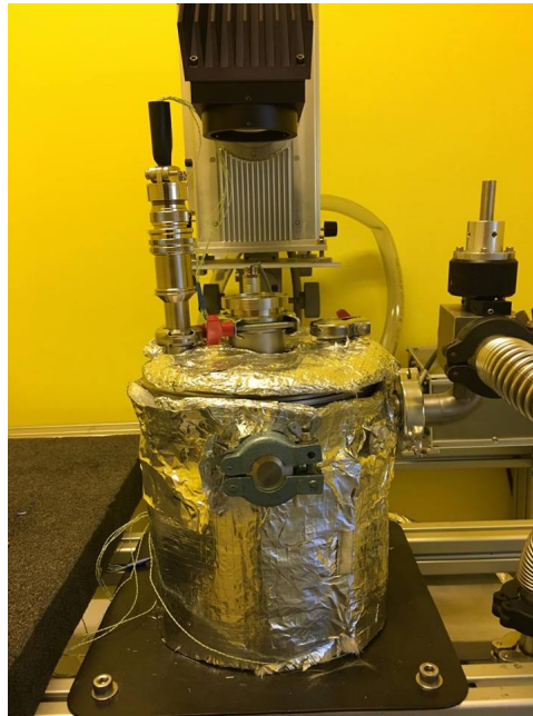
FIGURE 2.2 – Photographie du dispositif de caractérisations thermique et électrique de cellules photovoltaïques sous environnement contrôlé.
