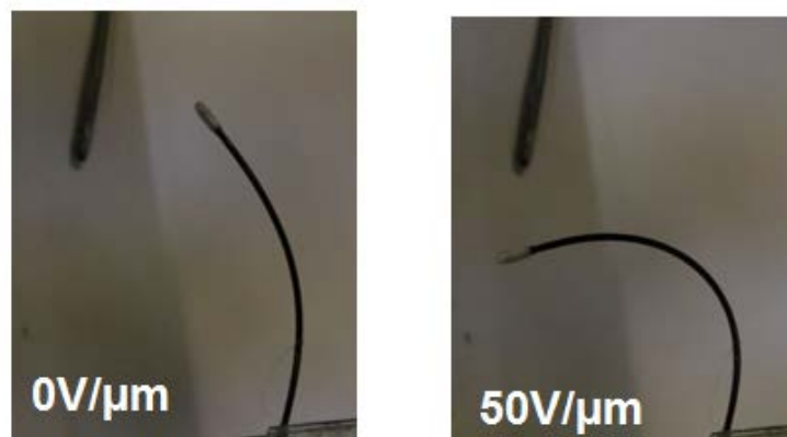
Figure 44 : Photographie du prototype de fil-guide pour deux niveaux d'excitation électrique
