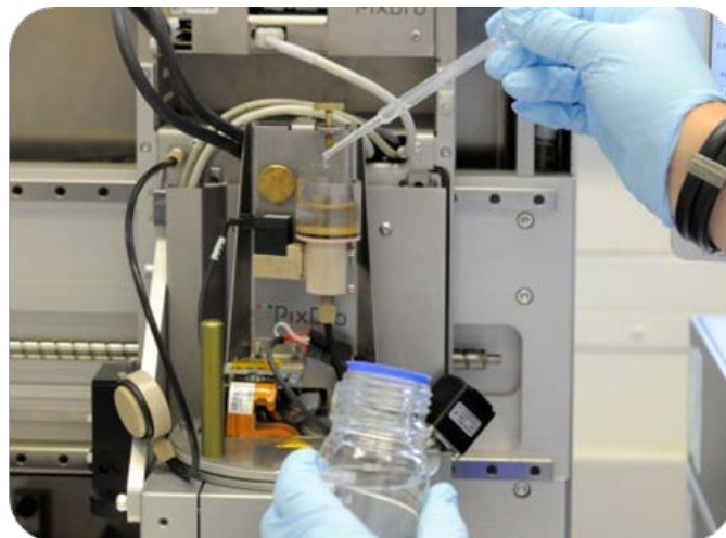
Figure 17 : Réservoir de la LP-50
