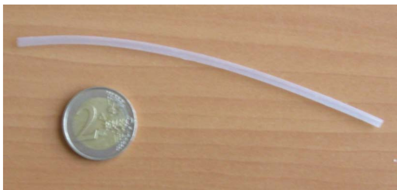
Figure 41 : Tube extrudé de P(VDF-TrFE-CFE) avec 15%wt de DINP
