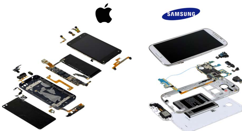
Figure 52. Vue éclatée de smartphones (extrait de [78])
