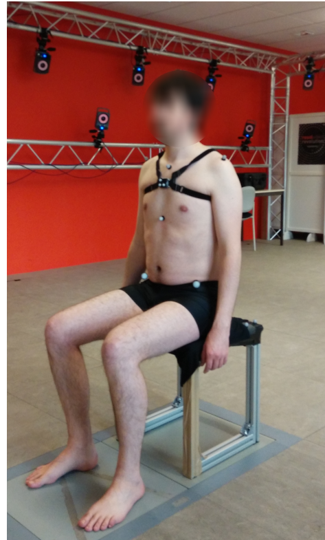
FIGURE 5.4 – Sujet équipé des marqueurs et de la centrale inertielle
