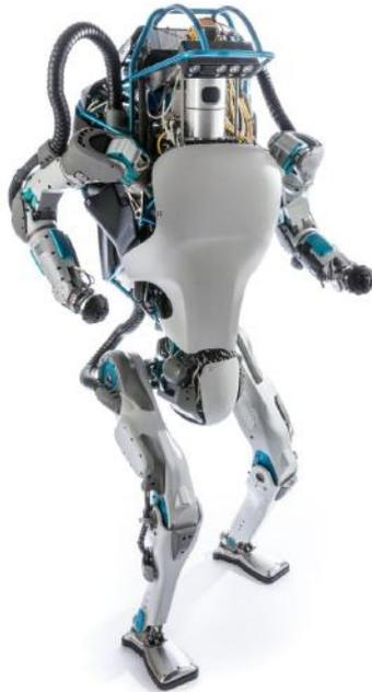
FIGURE 1.4 – Robot humanoïde ATLAS, conçu par la société Boston Dynamics
