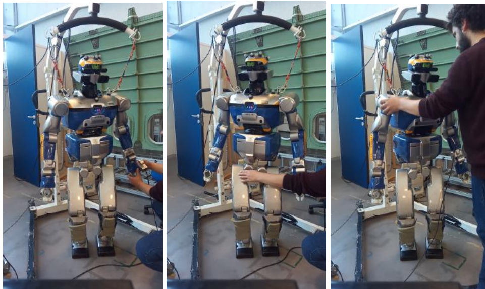
FIGURE 6.2 – Expérience de compensation de gravité sur le robot humanoïde HRP2 contrôlé en couple
