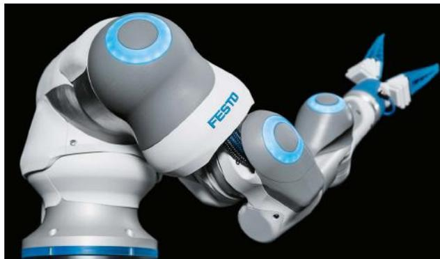
FIGURE 3.7 – Bras manipulateur BionicCobot pneumatique à 7 degrés de liberté, conçu par l’entreprise Festo.
