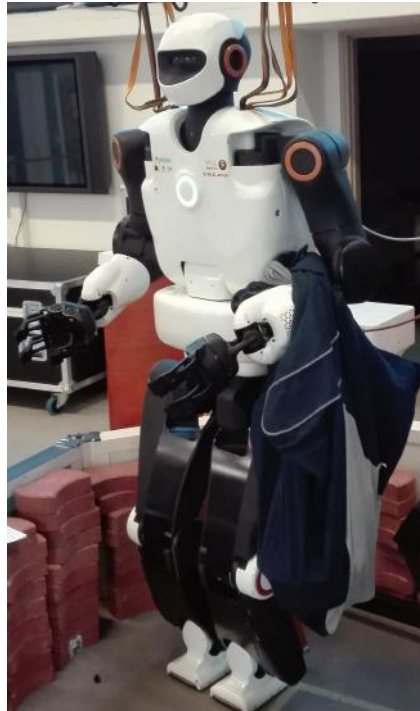
FIGURE 5.3 – Procédure expérimentale de génération d'un couple élevé sur l'articulation du coude du robot Talos afin de faire évoluer la température de l'actionneur.
