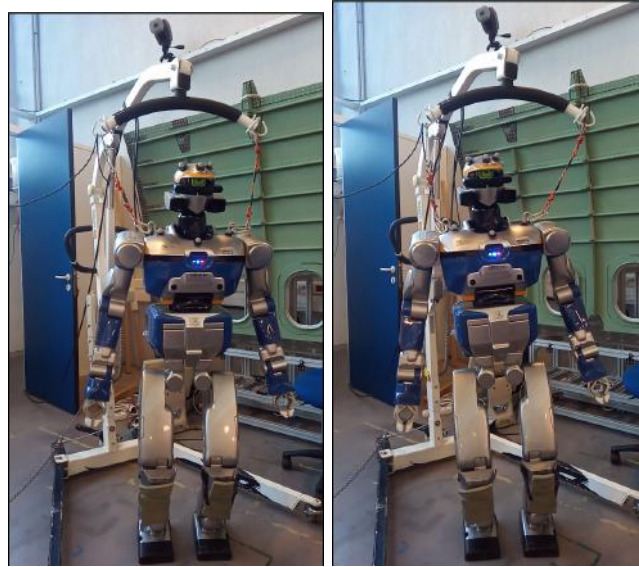
FIGURE 6.3 – Expérience de déplacement du centre de masse du robot humanoïde HRP2 contrôlé en couple
