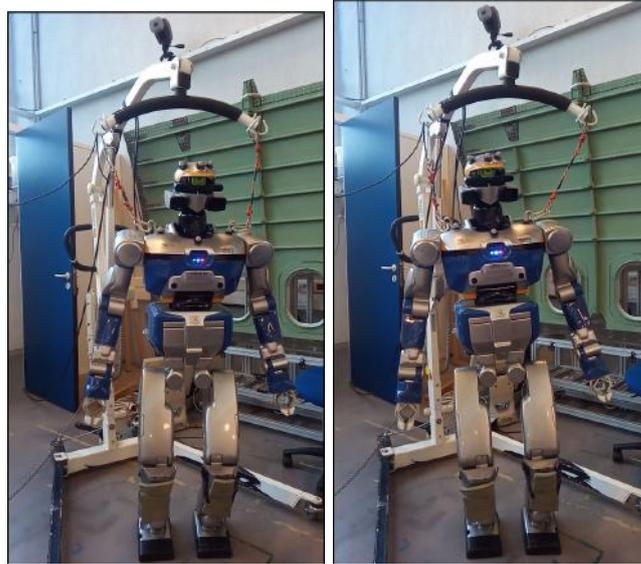
FIGURE 6.3 – Expérience de déplacement du centre de masse du robot humanoïde HRP2 contrôlé en couple
