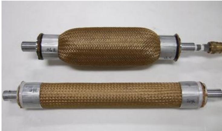
FIGURE 3.9 – Muscle artificiel pneumatique de McKibben
