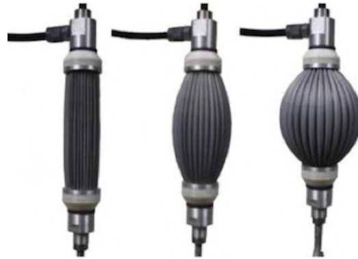
FIGURE 3.10 – Muscle artificiel de McKibben (PPAM 3.0) conçu par la Vrije Universiteit Brussel. On observe le muscle artificiel à différents niveaux de gonflage, on peut alors apprécier le changement de forme lié au gonflage de l'actionneur.
