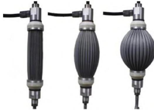
FIGURE 3.10 – Muscle artificiel de McKibben (PPAM 3.0) conçu par la Vrije Universiteit Brussel. On observe le muscle artificiel à différents niveaux de gonflage, on peut alors apprécier le changement de forme lié au gonflage de l'actionneur.
