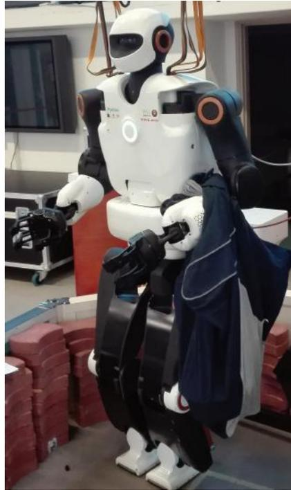
FIGURE 5.3 – Procédure expérimentale de génération d'un couple élevé sur l'articulation du coude du robot Talos afin de faire évoluer la température de l'actionneur.
