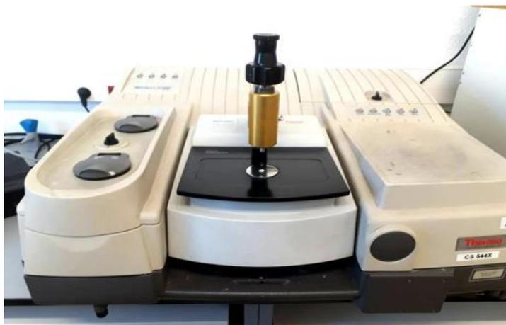
Figure 98 : Spectromètre à transformée de Fourier NICOLET 5700.
