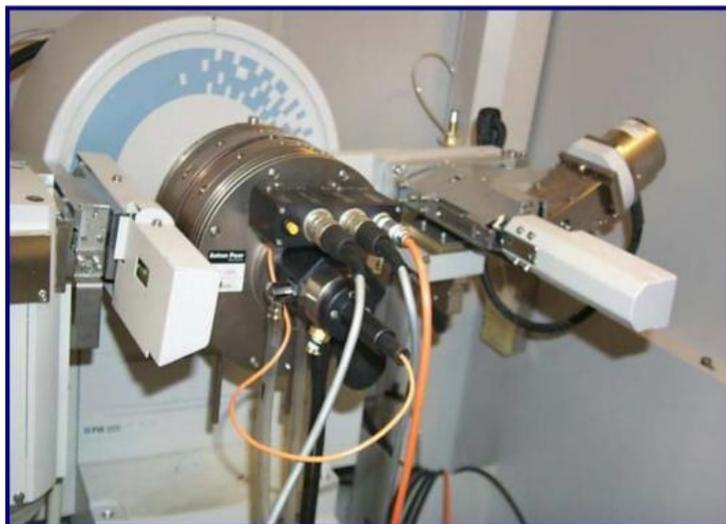
**Figure 96 : Chambre à haute température Anton Paar HTK 1200.**
