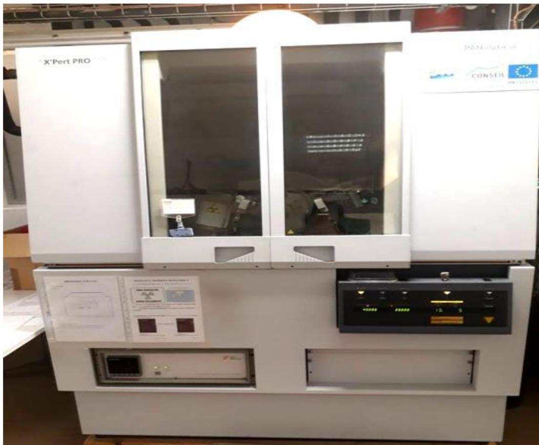
**Figure 95 : Diffractomètre X'pert Pro de PHILIPS.**
