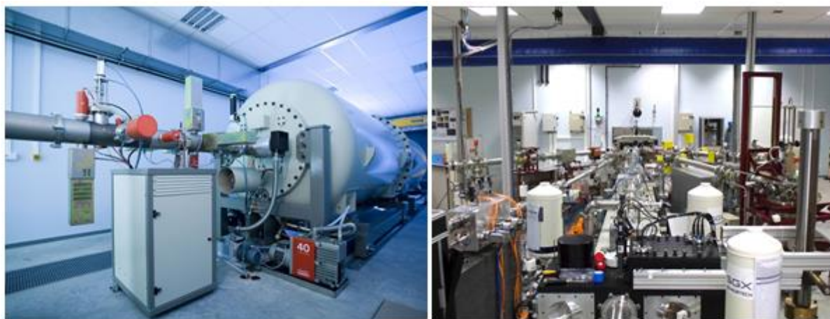
Figure 16. À gauche : l'accélérateur électrostatique simple étage de type 3,5 MV - Singletron d'AIFIRA, qui délivre des faisceaux d'ions ( ^1\text{H}^+ , ^2\text{D}^+ , ^4\text{He}^+ ) de basse énergie. À droite : vue des cinq lignes d'analyse, avec au centre la ligne nanofaisceau utilisée pour nos travaux.
