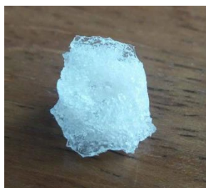
Figure 32. Scaffold d'un hybride collagène hydrolysé-bioverre fabriqué à partir de billes en PMMA.
