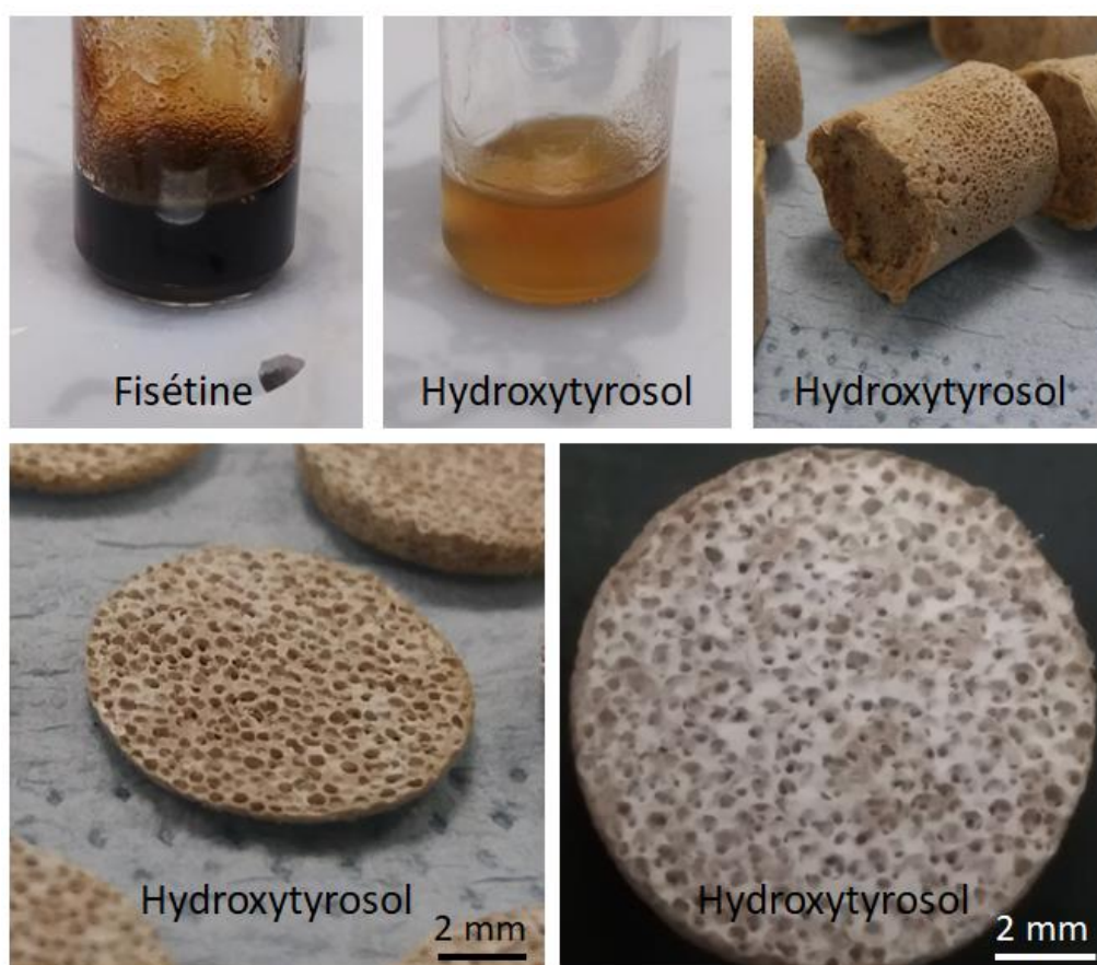
Figure 82. Solutions hybrides et scaffolds d'un hybride PCL-bioverre dopé avec la fisétine ou l'hydroxytyrosol.
