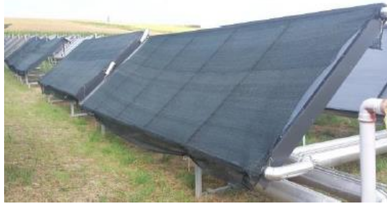
Figure 3-7 : Capteurs solaires recouverts de couvertures avec un facteur d'ombrage de 50% pour simuler une opacification [34].
