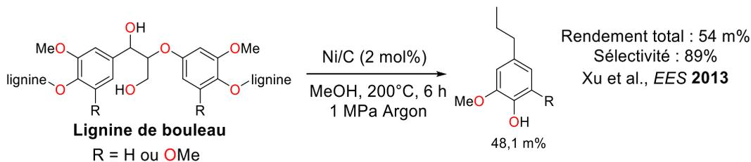
**Figure I.10 : Dépolymérisation réductrice de la lignine de bouleau avec un catalyseur de nickel sur charbon et du méthanol comme source d'hydrogène.<sup>53</sup>**
