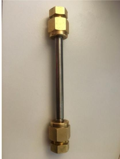
**Figure 35 :** Tube utilisé pour le prélèvement d'air dans les serres agricoles
