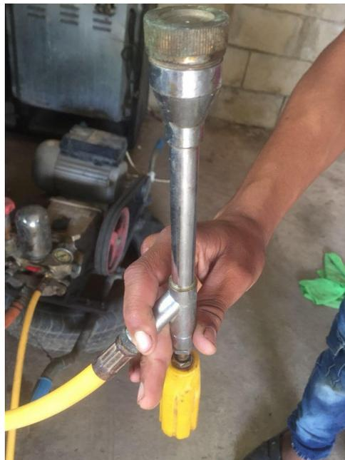
**Figure 31 :** Buse utilisée pour la pulvérisation
