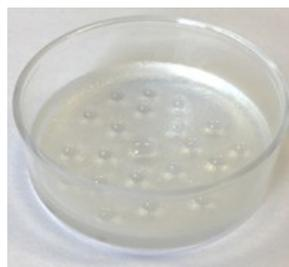
**Figure 24 :** Film de paraffine de 1mm d'épaisseur après dépôt de 100  $\mu\text{L}$  d'une solution de pesticide
