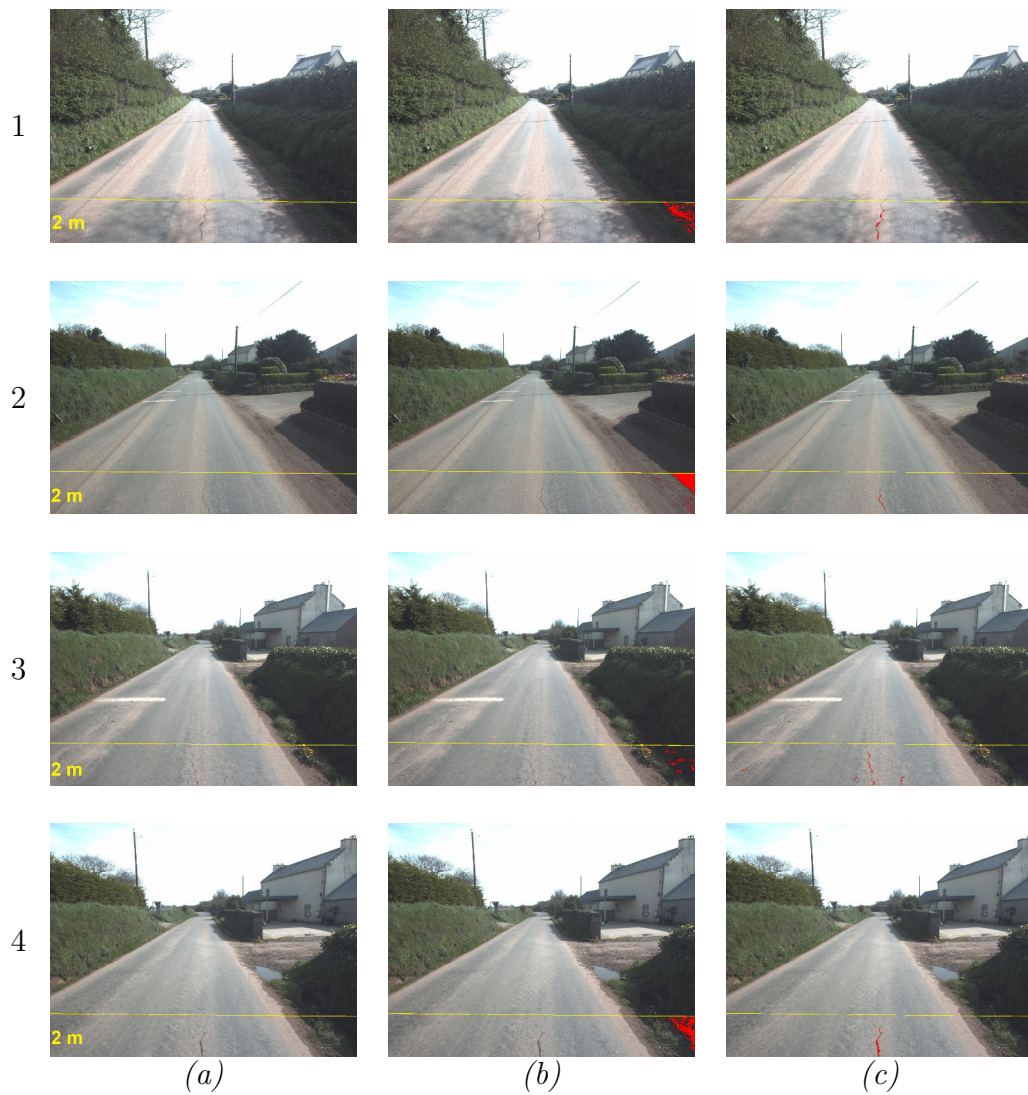
FIGURE 5.43 – Application de la méthode OMPS et la méthode ADFD sur des images VIAPIX ® de taille 1216 \times 1600 pixels acquises tout les 2 mètres – (a) Images originales - (b) Résultats OMPS - (c) Résultats ADFD.
