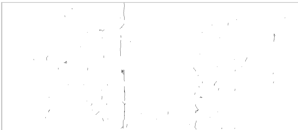
FIGURE 5.19 – Calcul des filaments sombres – Résultat obtenu lors de l'application de l'algorithme de Dijkstra sur les points amorces illustrés dans la figure 5.17.
