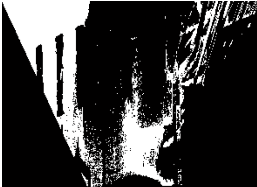
FIGURE 2.15 – Résultat de la détection de la route après le seuillage S_{route} – La partie de la route qui a été détectée est présentée en blanc.
