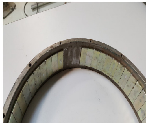
(d) Rotor with magnets
