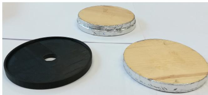
FIGURE 3.4 – Photo du support en plastique et d'un échantillon mis en place sur le support (fond).
