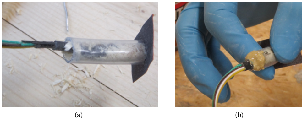
FIGURE C.1 – Photos de la mise en place des capteurs pour tester la réponse avec sciure : (a) étape 1 : capteur dans sciure, (b) étape 2 : mise en place de la pâte à bois.
