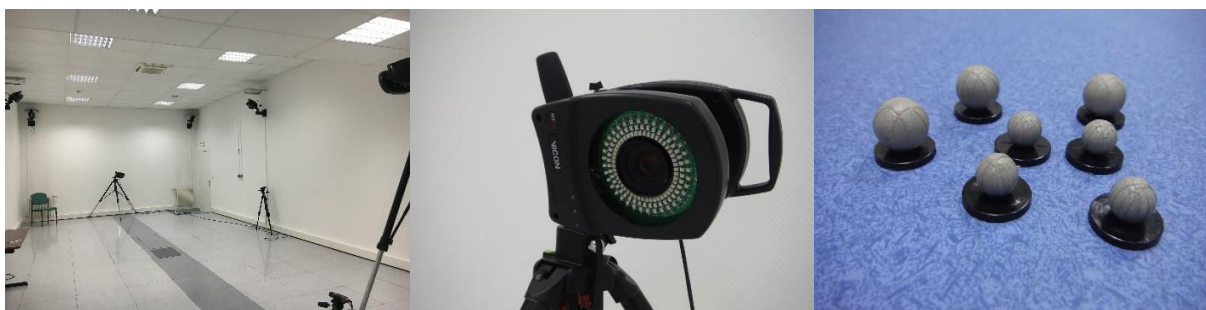
Figure 11. Système de capture du mouvement. Gauche: Laboratoire d'analyse du mouvement. Milieu: Caméra infrarouge VICON (Oxford, UK). Droite: marqueurs passifs rétro-réfléchissants.
