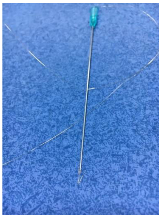
Figure 24. Electrodes EMG intramusculaires avec l'aiguille de mise en place des fils
