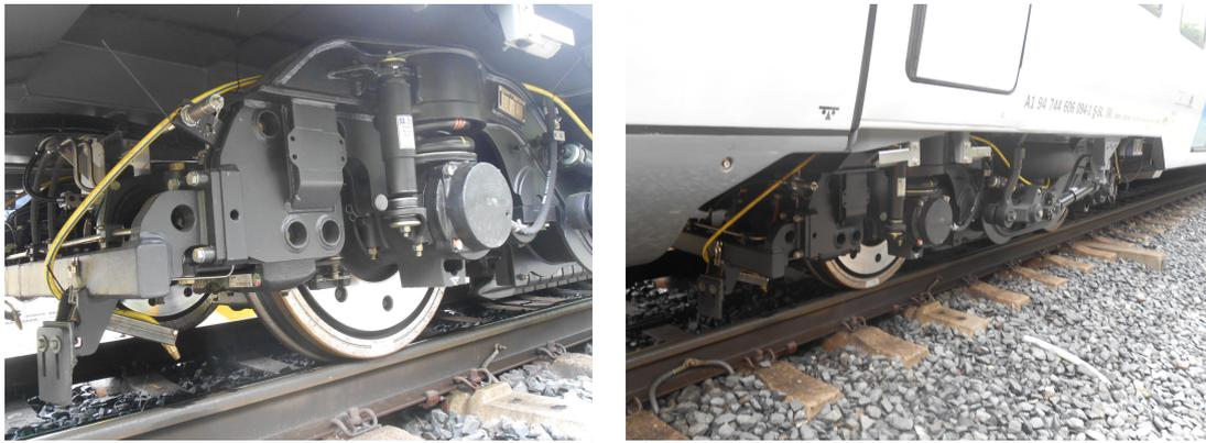
FIGURE 5.17 – Dispositif permettant d’arroser le rail pour les tests d’anti-patinage et anti-enrayage lors des essais sur train à Salzgitte.
