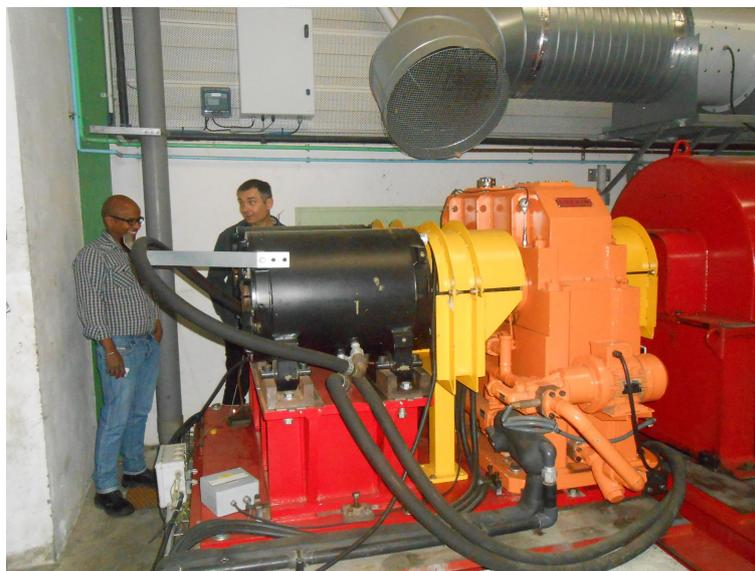
FIGURE 5.9 – Moteurs de traction utilisés lors des essais sur banc de puissance.
