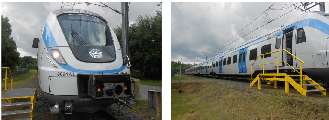
FIGURE 5.16 – Train régional suédois X60-b utilisé lors des essais sur train à Salzgitter.
