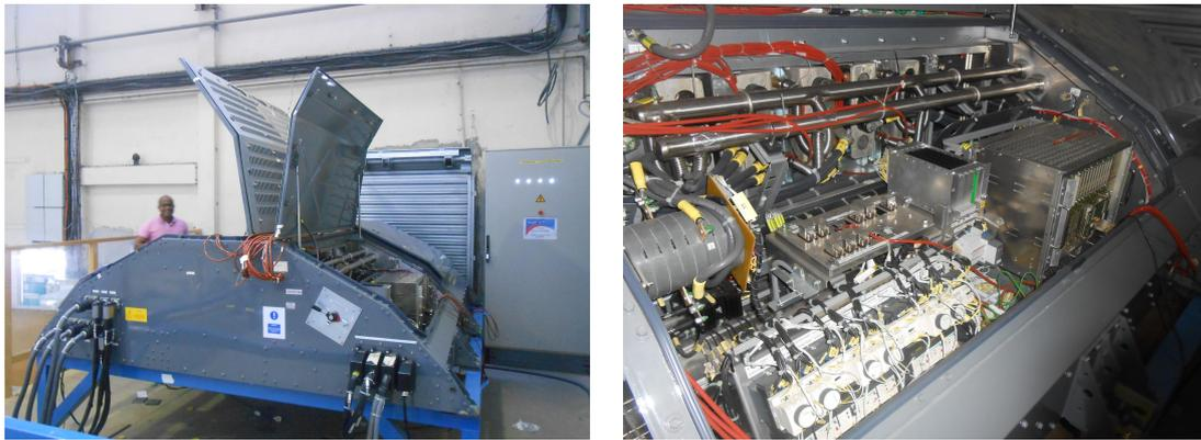
FIGURE 5.11 – Vues du coffre de traction utilisé et des différents composants qu'il intègre.
