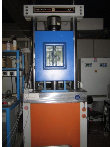
Figure 2-5. Vue générale de la presse hydraulique équipée de l'enceinte thermique
