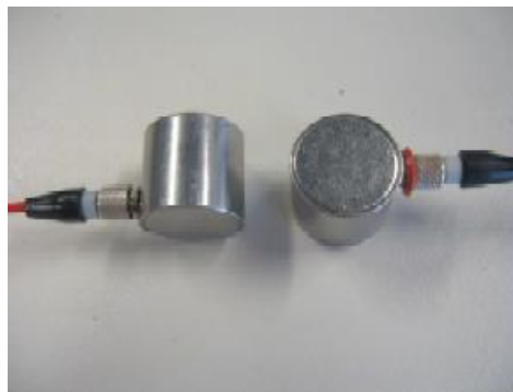
Figure 2-46. Photo des capteurs d'ondes de compression
