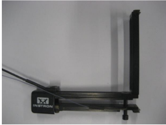
Figure 2-6. Extensomètre de mesure des déplacements axiaux
