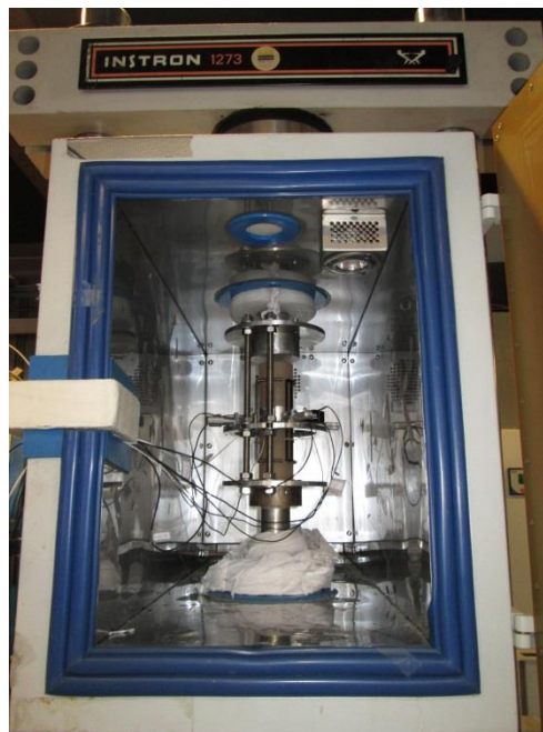
Figure 2-40. Calibration avec l'éprouvette Zérodur
