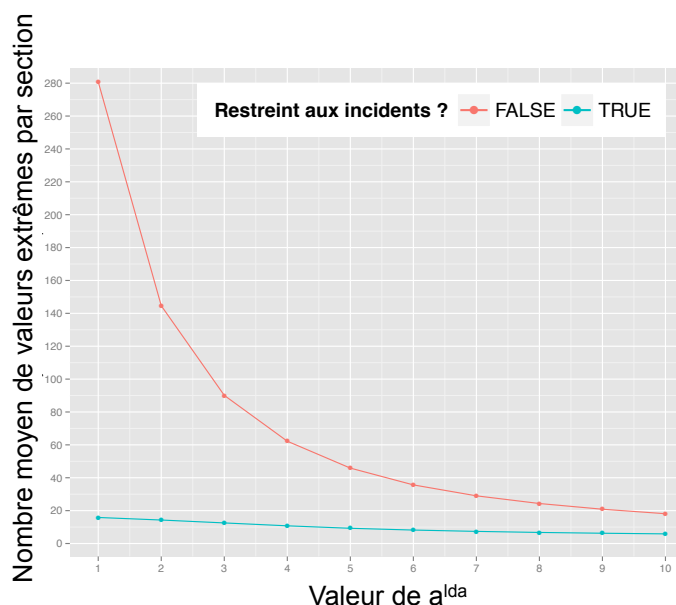
Fig. 5.5.: Illustration du procédé de sélection du paramètre a^{lda} optimal. Le nombre d'incidents détectés en fonction du a^{lda} et le nombre d'incidents réels et détectés sont conjointement représentés.
