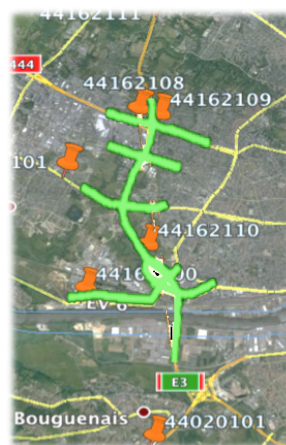
Fig. 6.3.: Positionnement des 6 capteurs MétéoFrance sur le réseau du Pont de Cheviré à Nantes.
