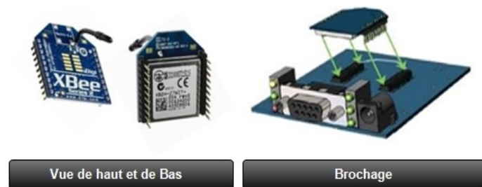
Figure 3. 10 : Le module XBee utilisé dans le système B-percept® XBee®/XBee-PRO® RF Modules. 802.15.4-v1. XBee (Datasheet. Digi international inc. 2009)
