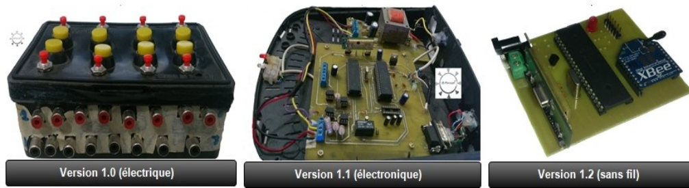
Figure 3. 5 : Illustration des trois versions du système B-percept ® marquant les trois principales étapes de son développement matériel. La version 1.0 représente la conception gérée de façon électrique. La version 1.1 est la première conception électronique embarquée filaire. La version 1.2 est celle qui marque le passage à la transmission des données sans fil
