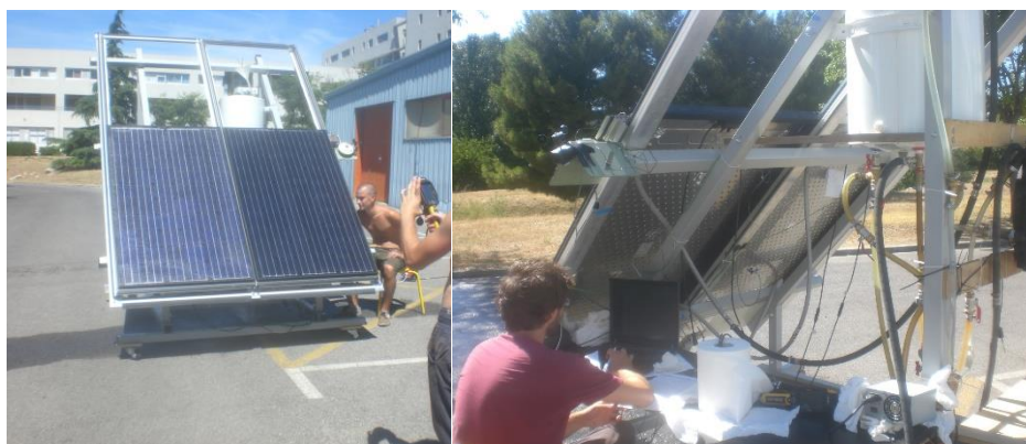
Figure 96 : Banc pour les prises de mesures infra-rouges
