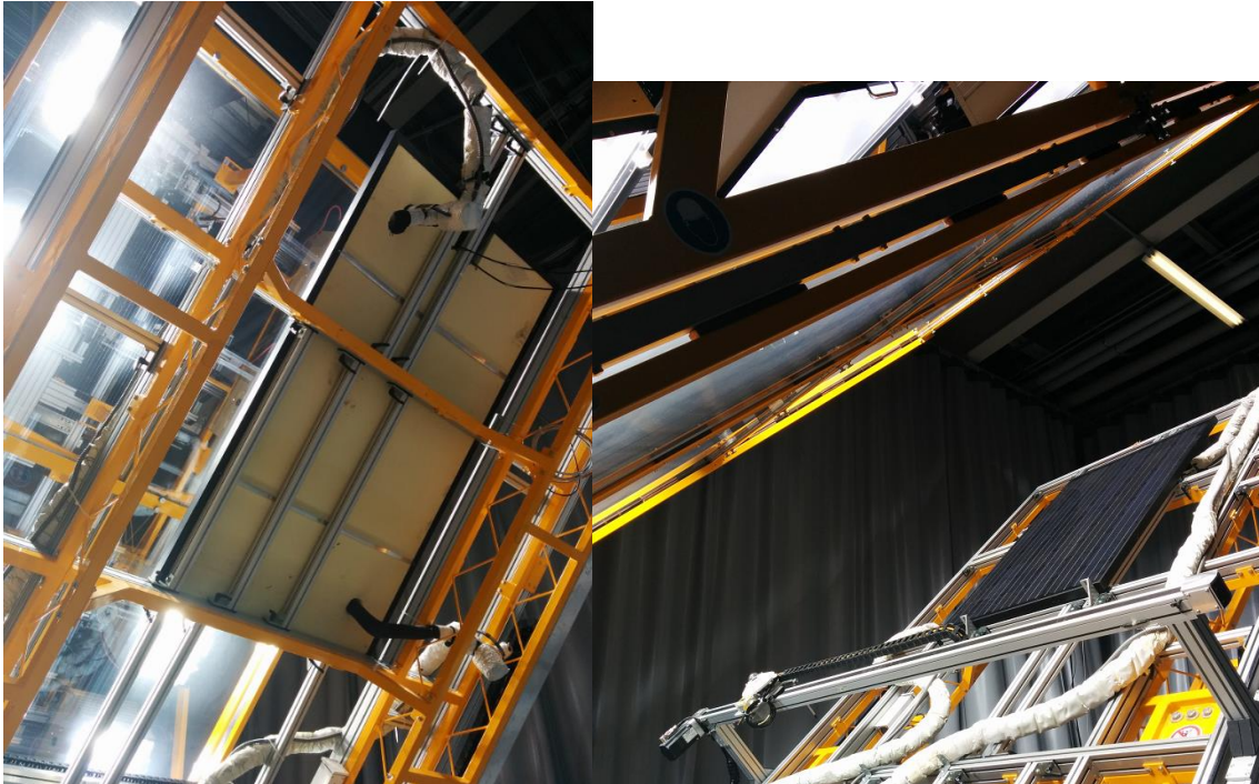
Figure 119 : Banc de mesures des performances en ensoleillement artificiel au CEA INES (France)
