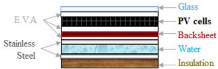
Figure 9 : Module hybride DualSun – vue en coupe
