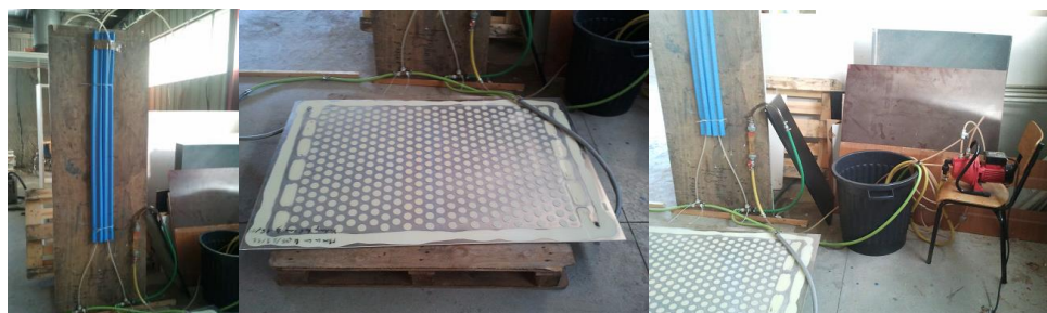
Figure 64 : Photographie du banc de test de perte de charge, interne
