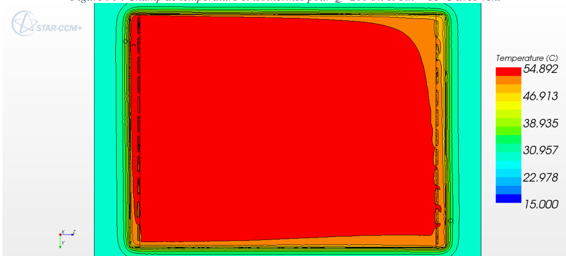
Figure 91 : Champ de température et isothermes pour Q=200 l/h et T_{in} = 45^\circ C avec vent
