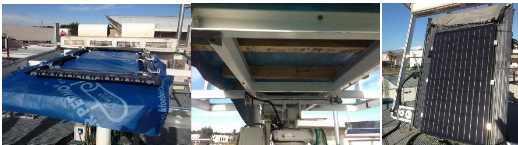
Figure 131 : Banc de test CESP pour la mesure de température de stagnation en « intégré »
