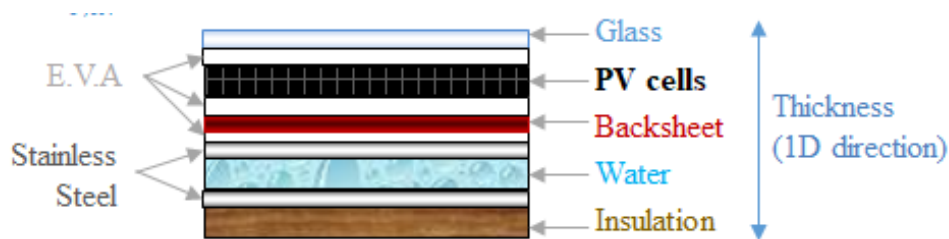
Figure 133 : Schéma de l'empilement des couches
