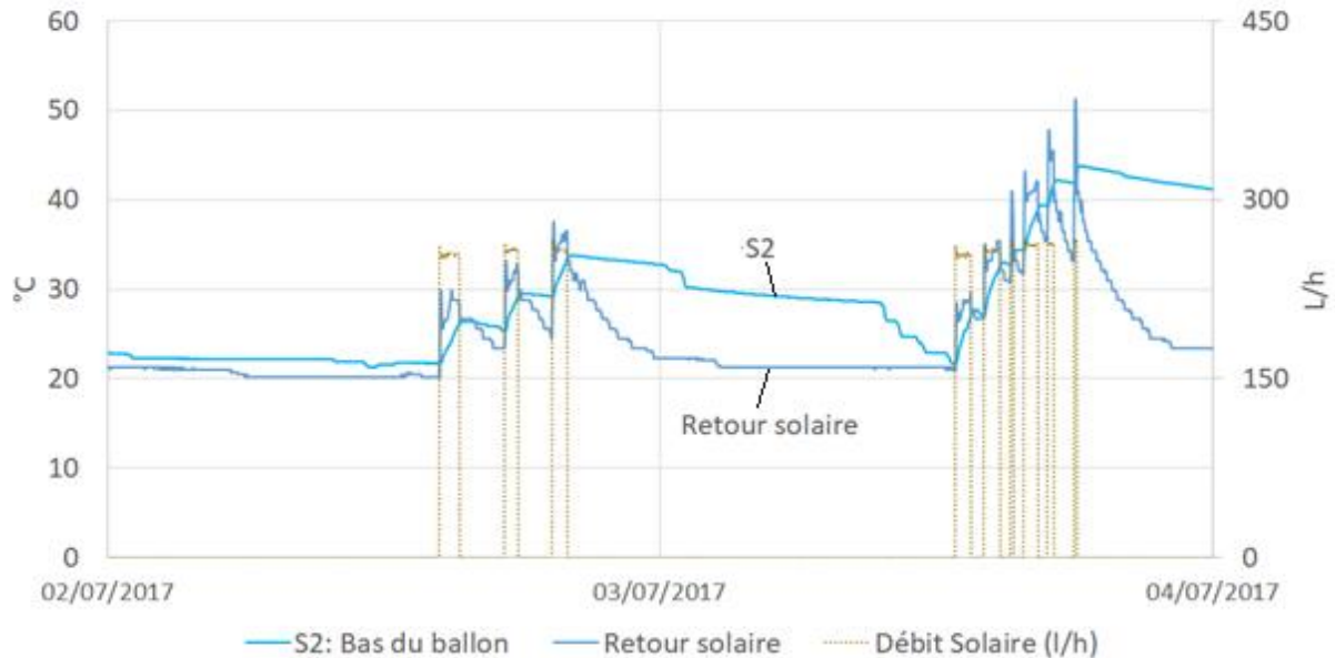
Figure 169 : Ambérieu-en-Bugey, données brutes des températures du bas de ballon et sortie côté circuit primaire du ballon (Retour Solaire) et du débit solaire
