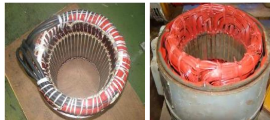
Figure 26: Tête de bobine de bobinages distribués.
