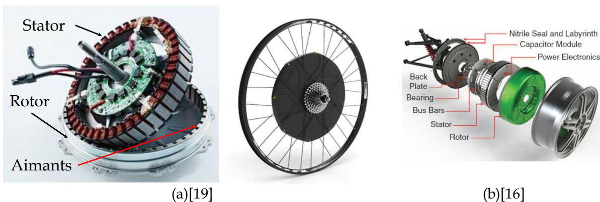
Figure 18: Moteur roue à flux radial : (a) VAE - (b) VE
