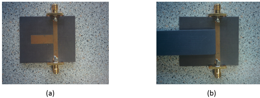
Figure 3.13 – Résonateur parallèle à vide en (a) et chargé par la résine de polyuréthane UR5044 en (b)
