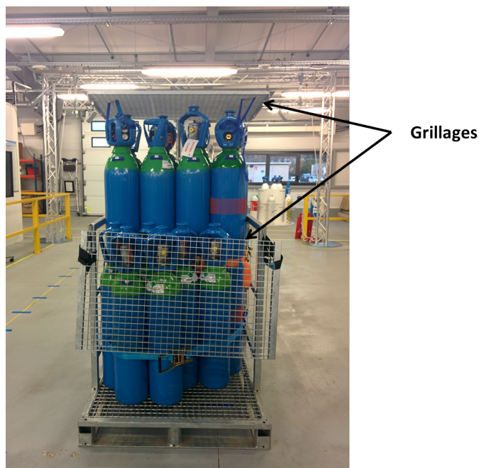
Figure 2.19 – Panier chargé de 8 bouteilles B50 avec chacune 2 tags, 6 bouteilles B20 équipées d’un seul tag chacune et deux grillages métalliques, un au dessus et un second devant les B20
