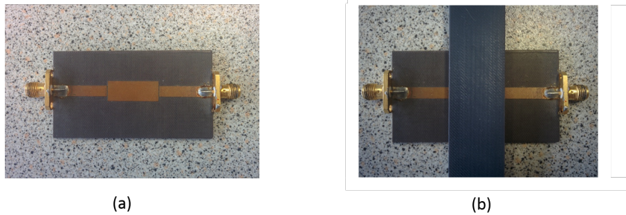
Figure 3.12 – Résonateur série à vide en (a) et chargé par la résine de polyuréthane UR5044 en (b)
