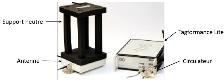
Figure 3.10 – Banc expérimental Hand Carry Kit servant à la caractérisation des performances du tag
