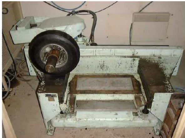
Figure 4-2 : Table de compactage à pneu type LPC.
