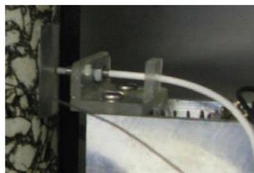
Figure 4-6 : Capteur sans contact sur son support avec cible en aluminium collée à la surface de l'éprouvette.
