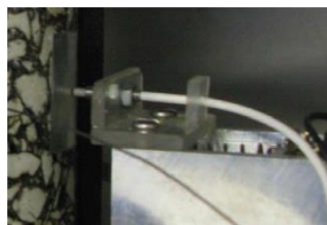
Figure 4-6 : Capteur sans contact sur son support avec cible en aluminium collée à la surface de l'éprouvette.
