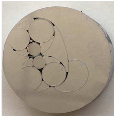
Figure II.3 : Enrobage des échantillons dans du métal de Wood pour l'EBSD
