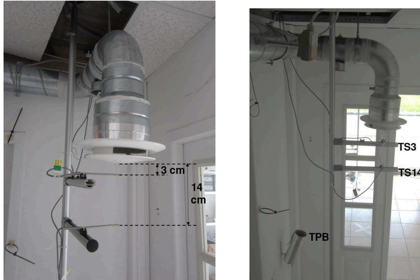
(a) Bouche de soufflage au RDC et sondes de température sous la bouche (b) Vue globale du point d'insufflation
