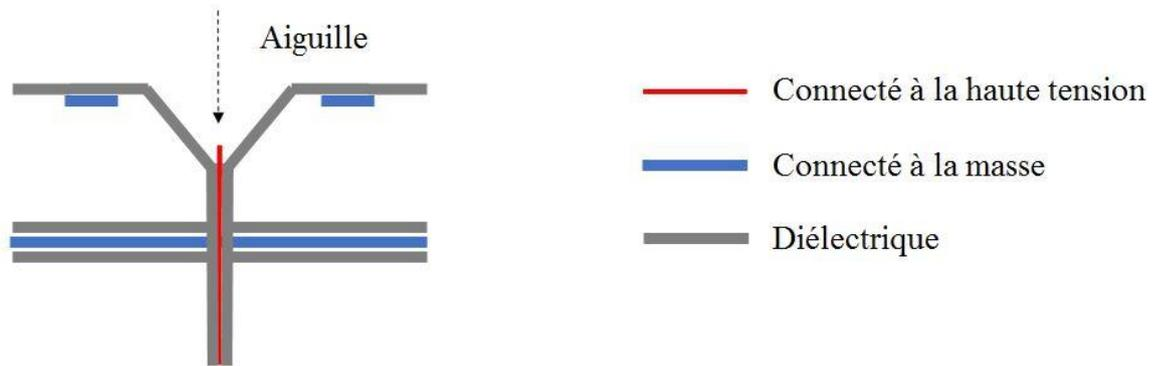
Figure III-6 : Schéma d'une aiguille de décharge de TIP4.
