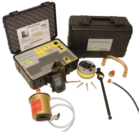
FIGURE 4.7 – Gas Tracker : matériel de la technique vibro-acoustique utilisée.
