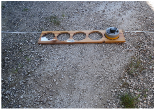
Figure 8 : Acquisition Gas Tracker en utilisant le gabarit
