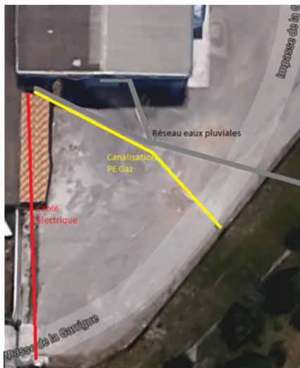
Figure 3 : Réseaux enterrés sur le parking de la société Made
